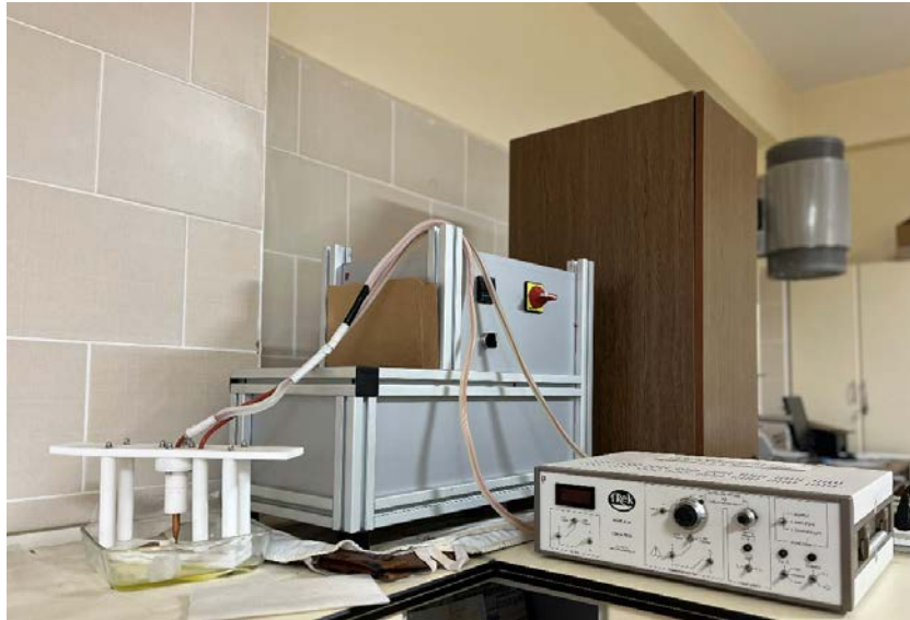
Resim 3.4 Kutuplama işlemlerinde kullanılan silikon yağı banyosu ve TREK 610E yüksek voltaj kaynağı.
