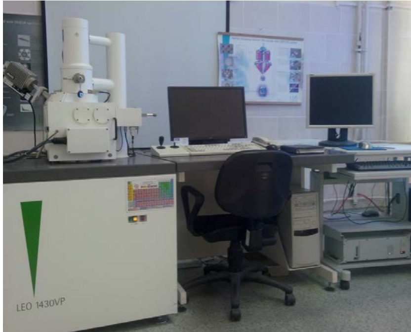
Resim 3.3 Mikroyapı incelemesinde kullanılan LEO 1430VP SEM cihazı.
