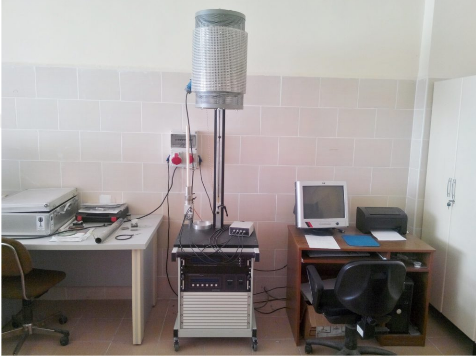
Resim 3.5 Novotherm HT-1200 dielektrik spektrometre cihazı.
