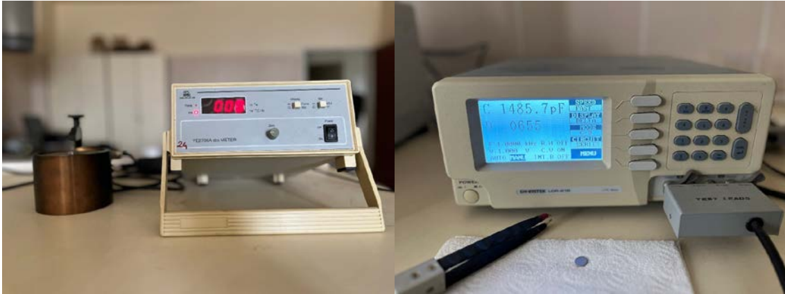
Resim 3.6 Yaşlanma ölçümlerinin ve diğer elektriksel ölçümlerin alındığı a) YE2730A d_{33} -metre ve b) GW-INSTTEK LCR-816 LCR-metre cihazları.
