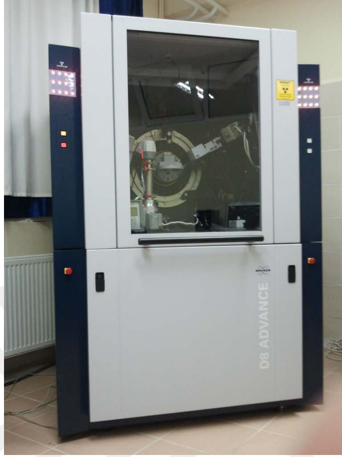
Resim 3.2 Minerolojik analizlerde kullanılan Bruker D8 Advance XRD cihazı.
