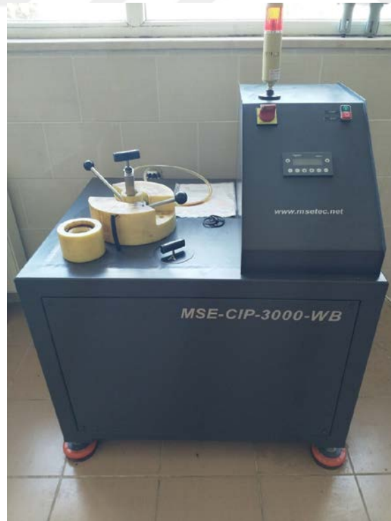
Resim 3.1 AKÜ TUAM bünyesinde bulunan Numune şekillendirmede kullanılan CIP cihazı.
