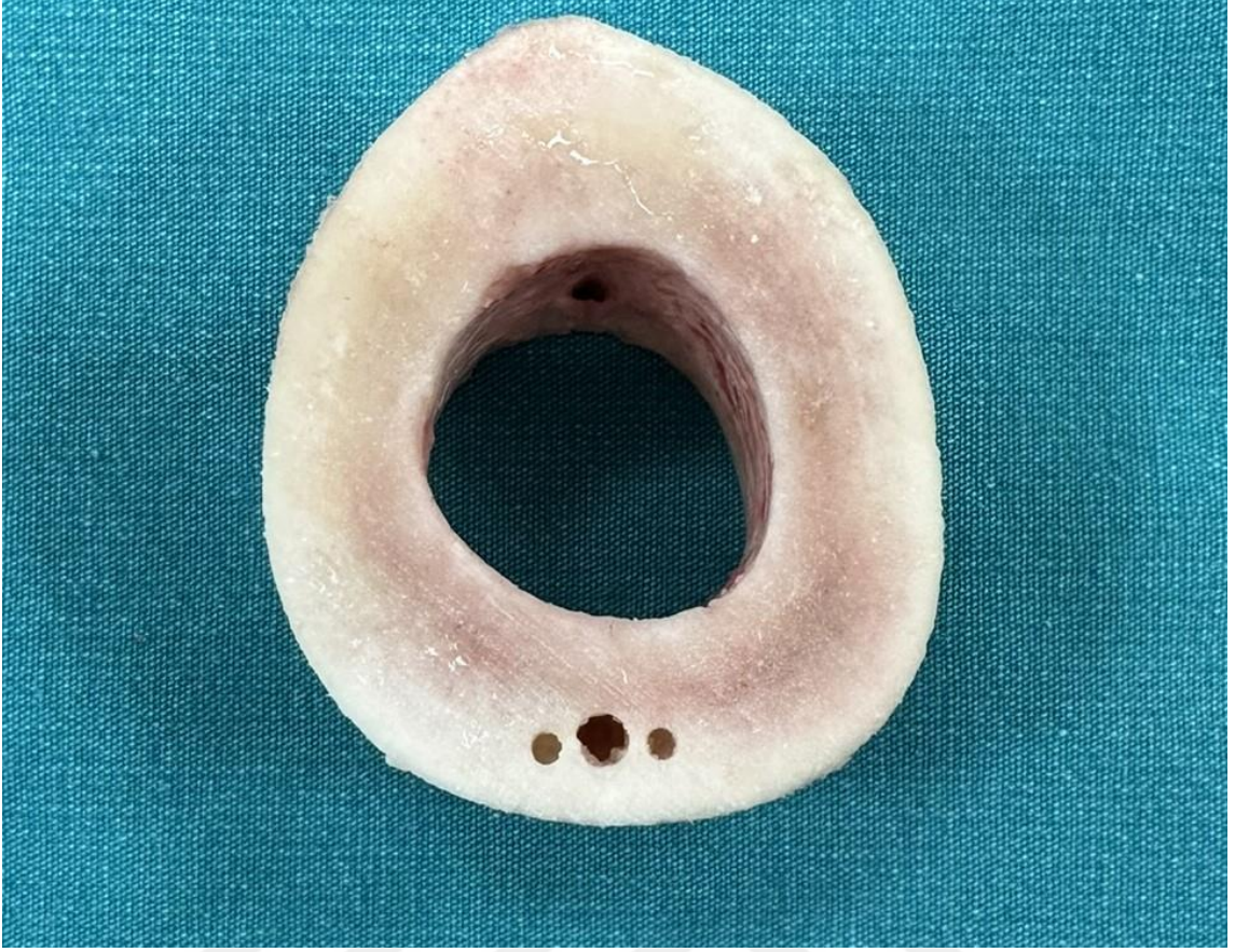
Resim 3.5. Drilleme yapılan bölgenin 1 mm uzağındaki ısı sensörlerinin yerleri
