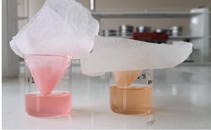
Resim 3.13. Sosis örneklerinin filtre edilmesi
