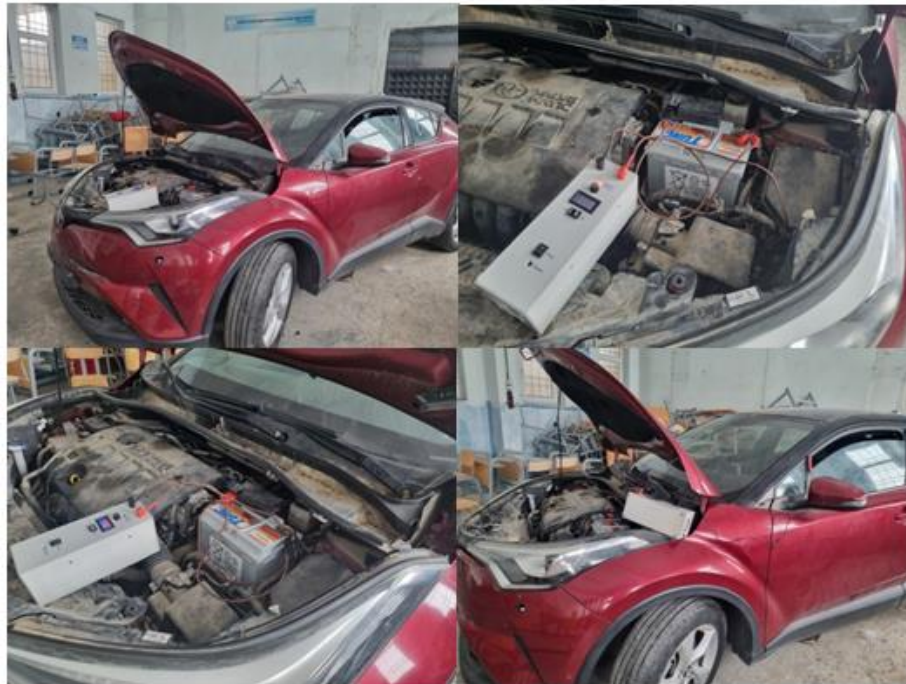
Şekil 3.4. Yedek güç ünitesinin araç üzerinde test edilmesi
