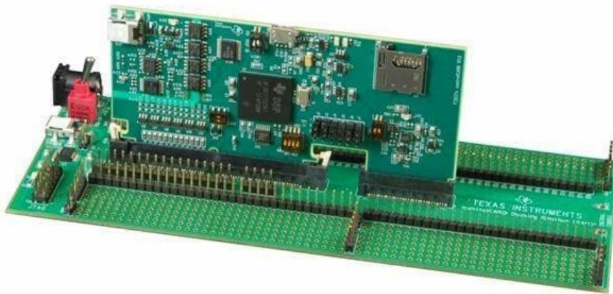
Şekil 7.5 TMDSDOCK28379D kodlu SSİ işlemcisi
