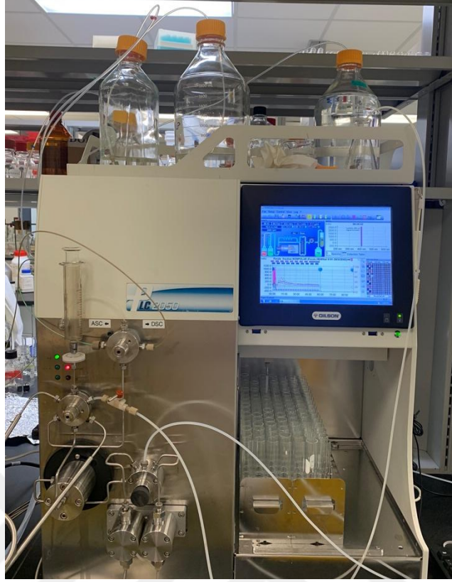
Şekil 3-1: Santrifüjlü Partisyon Kromatografisi (CPC), University of Illinois at Chicago, Amerika Birleşik Devletleri
