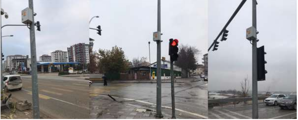
Şekil 3.3 Sayım verisi toplamak için sahada kurulan Bluetooth cihazları.
