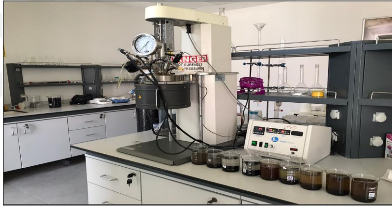
Şekil 3.4 Yüksek sıcaklık ve yüksek basınç koşullarında indirgenmiş grafen oksit sentezi için deneysel sistem
