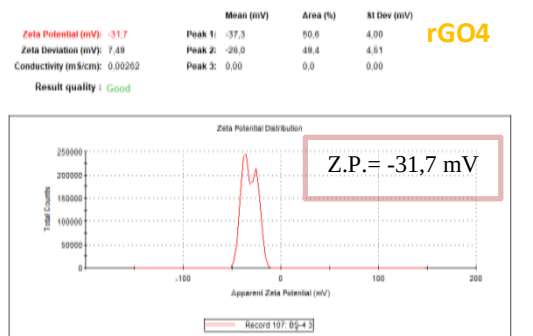
Şekil 4.8 L_9(3^4) deney tasarımı ile grafitten modifiye Hummers yöntemi ile grafen oksit sentezinin şematik gösterimi sentezi deneylerine ait Zeta-Sizer görüntüleri
