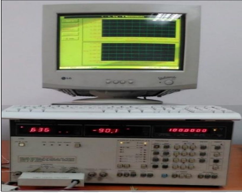
Şekil 3.3. HP 4192A LF empedans analizörü
