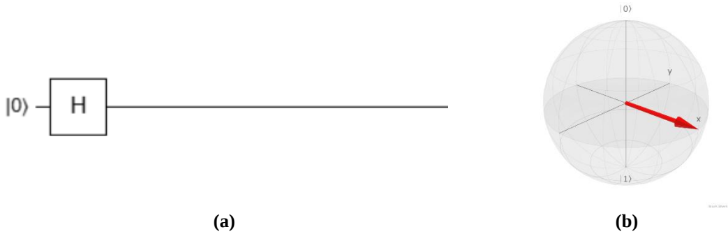
Şekil 4.3. Süper-pozisyon, (a)bir kübiti süper-pozisyona geçiren devre, (b) süper-pozisyon durumundaki kubitin bloch küresi gösterimi
