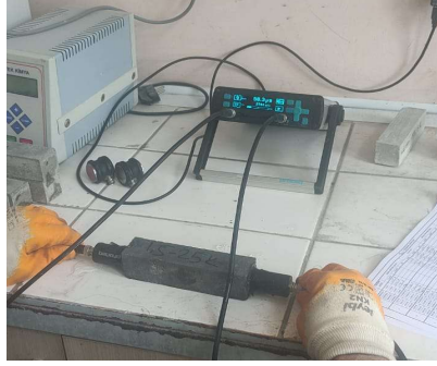
Fotoğraf 6.3 U_{pv} deneyinin yapılışı
