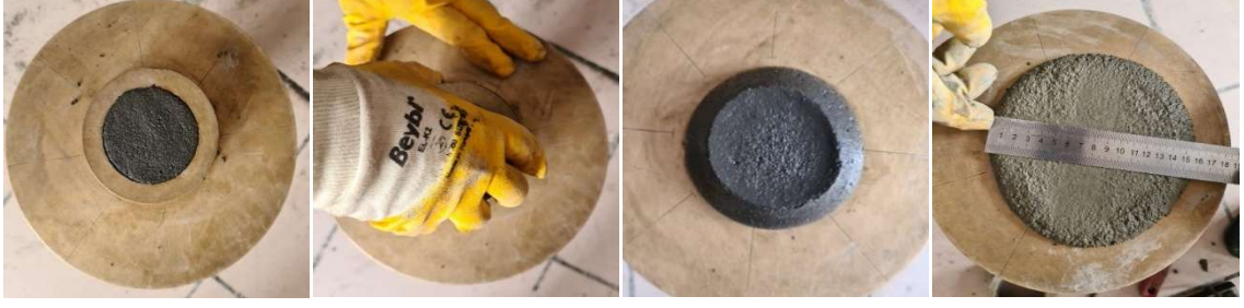
Fotoğraf 6.2 Yayılma deneyi
