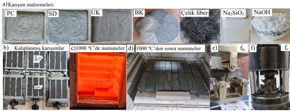
Fotoğraf 6.1. a) Karışım malzemeleri, b) kalıplanmış karışımlar, c) 1000 °C’deki numuneler, d) 1000 °C’den sonra numuneler, e) f_{fs} testi ve f) f_c testi.
