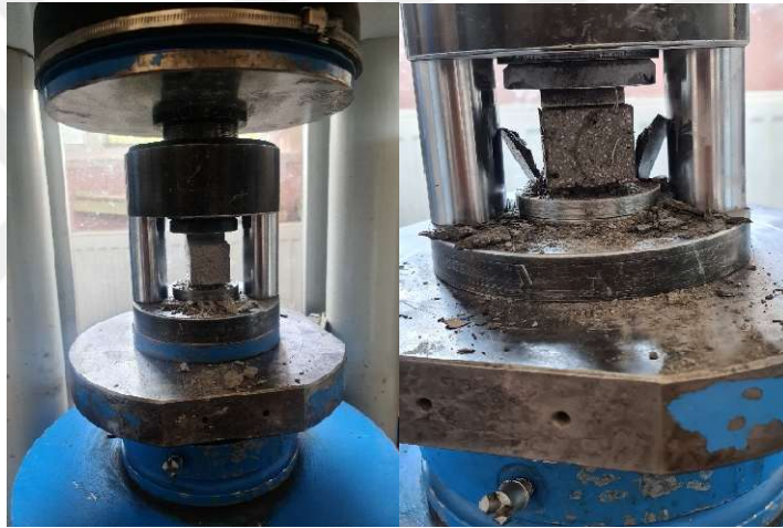
Fotoğraf 6.5 f_c deneyinin yapılışı
