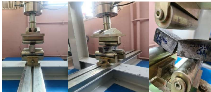
Fotoğraf 6.4 f_{fs} deneyinin yapılışı
