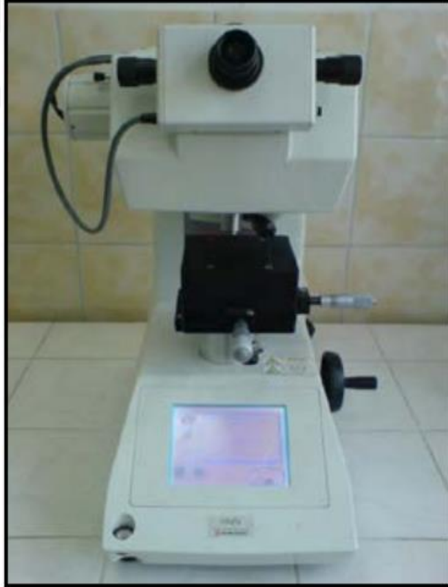
Şekil 5.8. Sertlik ölçümlerinde kullanılan Shimadzu HMV2 mikrosertlik test cihazı.
