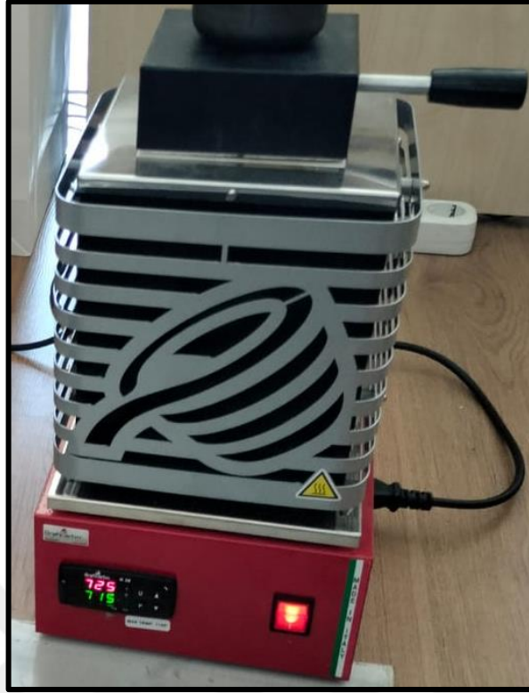
Şekil 5.2. Deney numunelerinin üretiminde kullanılan elektrik rezistanslı fırın.
