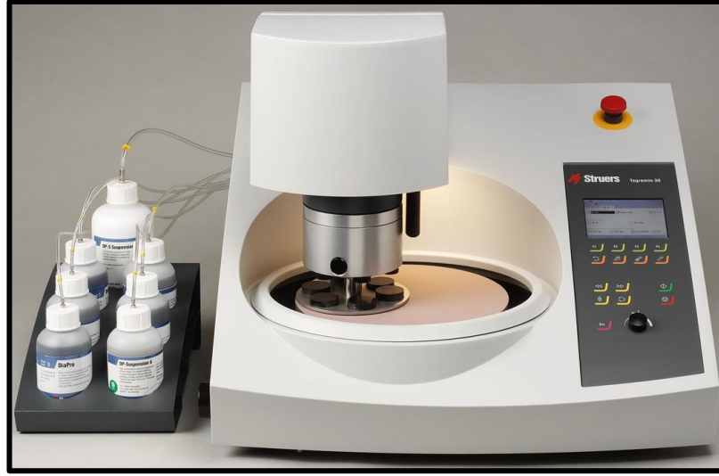
Şekil 5.6 Tegramin-30 otomatik zımparalama ve parlatma cihazı.
