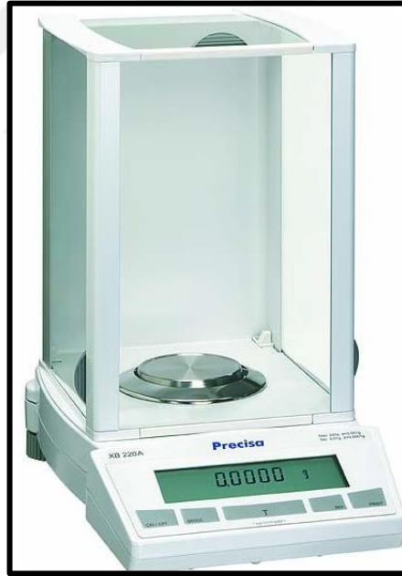
Şekil 5.1. Precisa marka XS 220A model 0,1 mg hassasiyete sahip elektronik terazi.
