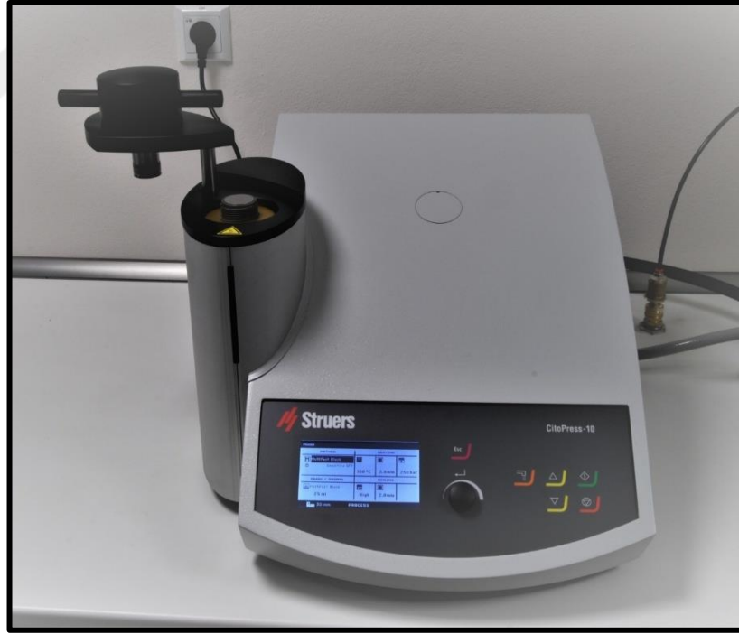
Şekil 5.5. Citopres 10 sıcak kaplama makinesi.
