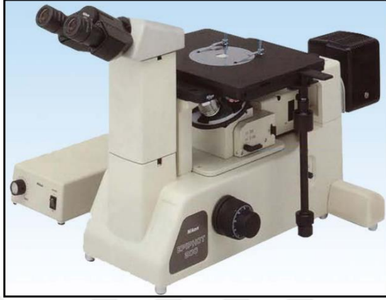
Şekil 5.7. Mikroyapı ve karakterizasyon incelemelerinde kullanılan Nikon Epiphot 200 Model optik ışık mikroskobu.
