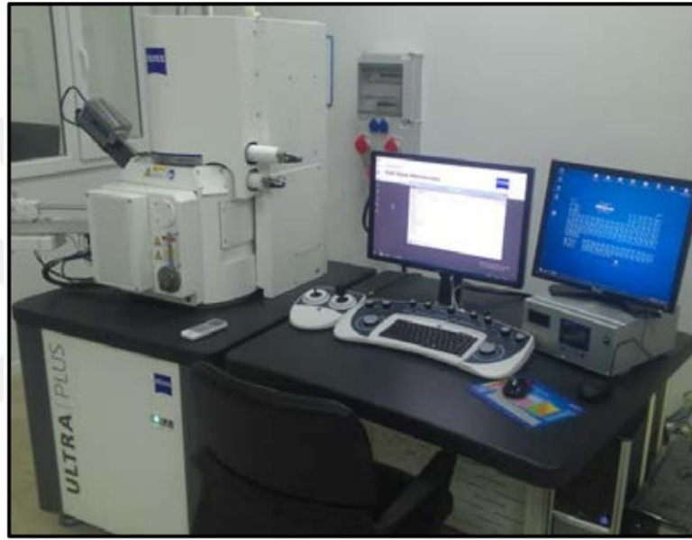
Şekil 5.11. Carl Zeiss Ultra Plus Gemini Fesem marka EDS aparatlı taramalı elektron mikroskobu (SEM).
