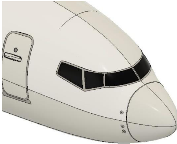
Şekil 7. Uçak burnunda (radom) kullanılan cam elyaf takviyeli kompozit (Brown, 2024).
