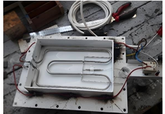
Şekil 54. Kalıba eklenen rezistans ve termostat devresi
