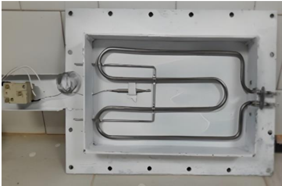
Şekil 54. Kalıba eklenen rezistans ve termostat devresi
