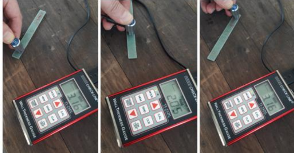
Şekil 97. Check-Line T1-250 L cihazı ile hasar tespiti
