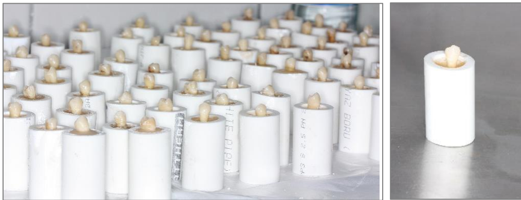
Resim 3.5. 25 mm çapında, 40 mm boyunda plastik manşona dik şekilde gömülü üst premolar dişler
