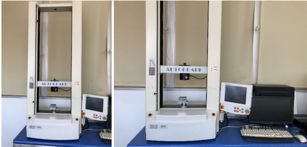
Resim 3.12. Autograph AG-IS Universal test cihazı (Shimadzu, Autograph AG-IS, Japonya)
