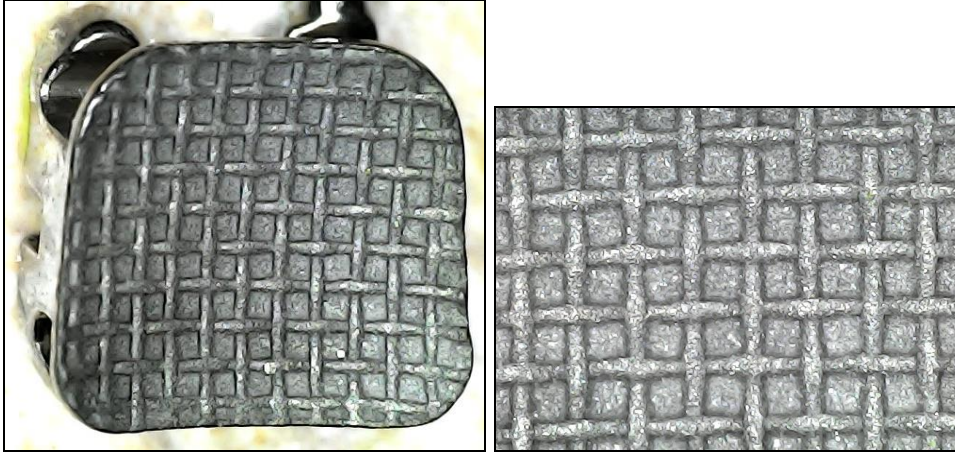
Resim 3.21. Yeni braket taban stereomikroskop görüntüleri
