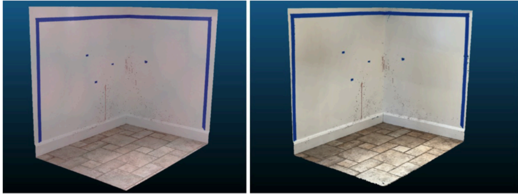
Şekil 1.26. Faro S350 ile yapılan mekansal tarama (solda), Recon 3D ile yapılan mekansal tarama (sağda) (Stevenson ve Liscio, 2024).
