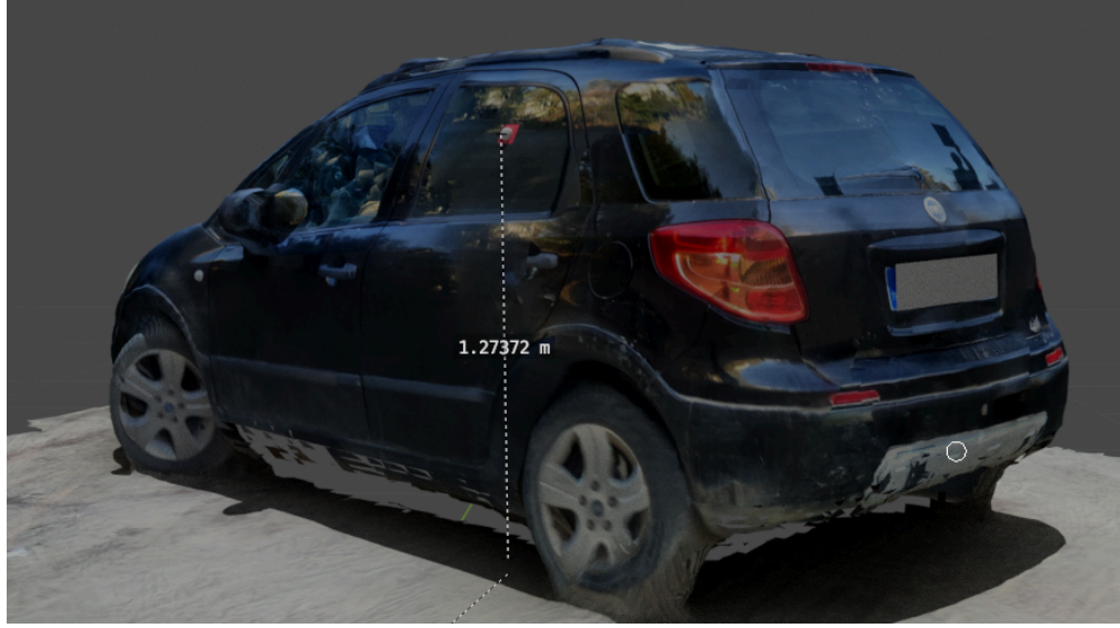
Şekil 3.27. Mermi giriş deliğinin zeminden yüksekliği (127cm) Not: Şerit metre ile yapılan ölçümde temsili giriş noktasının yerden yüksekliği 127 cm olarak ölçülmüştür.
