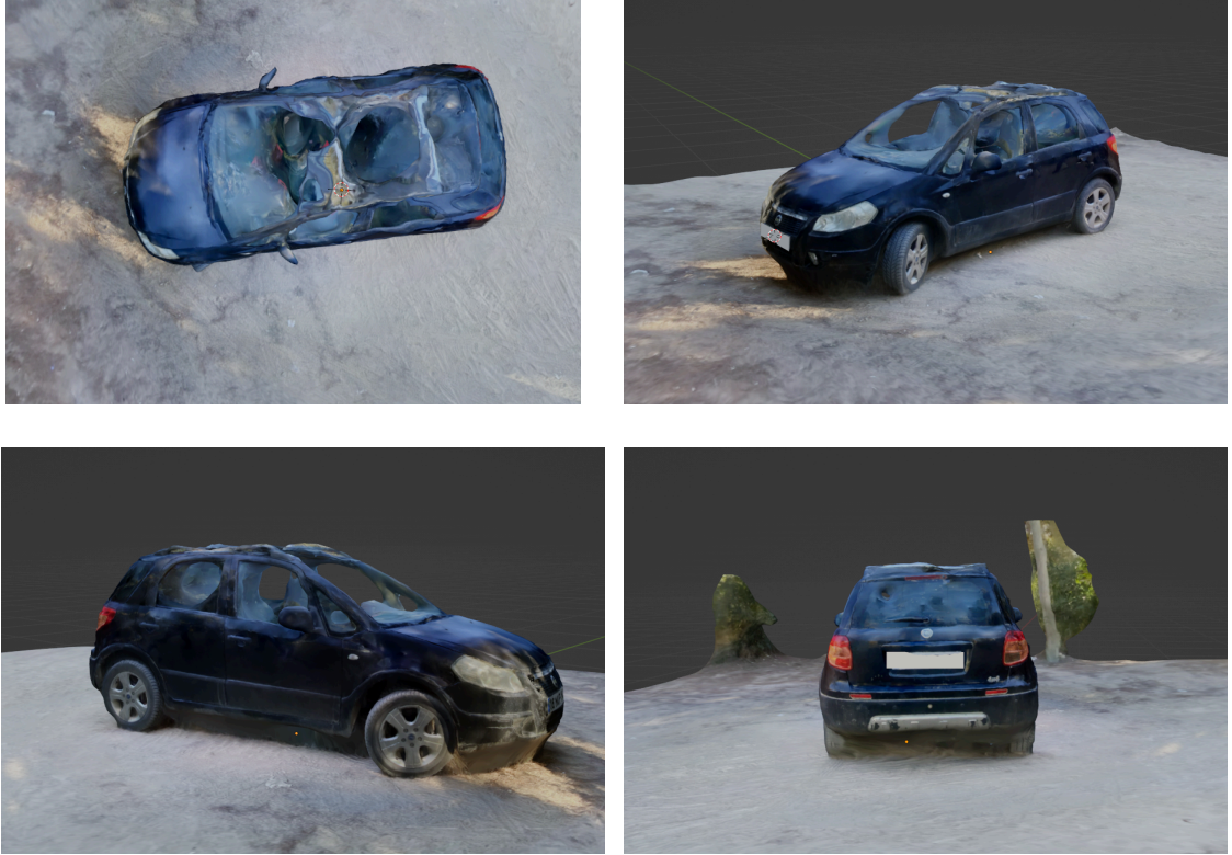
Şekil 3.6. 3D Scanner App dış mekan otomobil Photogrammetry tarama sonuçları (Tarama süresi: 2 dk 15 sn, işleme süresi: 13 dk, 50484 vertices)
