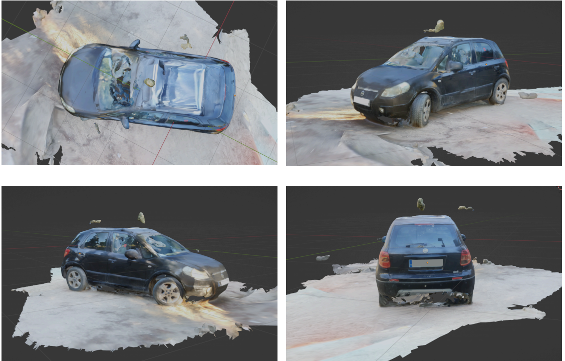
Şekil 3.9. MetaScan dış mekan otomobil LiDAR tarama sonuçları (Tarama süresi: 2 dk 05 sn, işleme süresi 34 sn, 31224 vertices)
