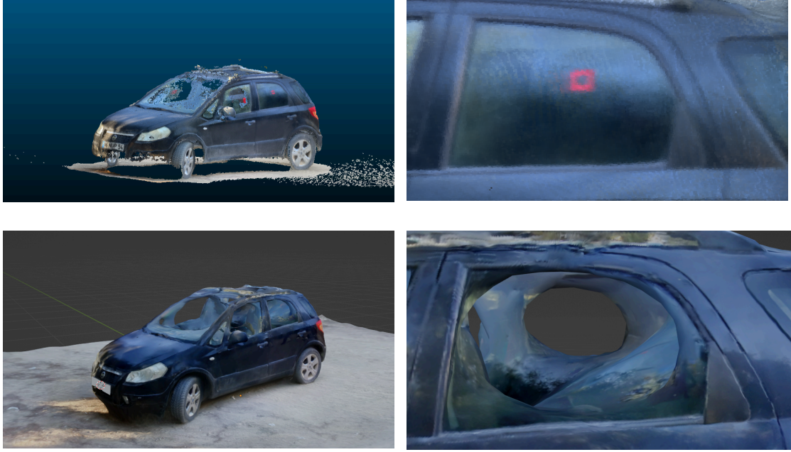
Şekil 3.19. 3D Scanner App-LiDAR (1. Sıra), MetaScan-LiDAR (2. Sıra), Recon3D-LiDAR (3. Sıra) ve 3D Scanner App-Photogrammetry (4. Sıra) dış mekan-otomobil tarama sonuçları
