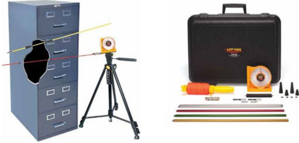
Şekil 1.15. Sondaj yöntemi ile yapılan mermi yolu ölçümü ve kullanılan ekipmanlar (Penven, 2018).
