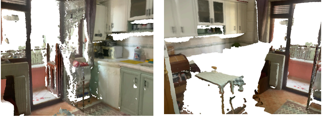
Şekil 3.14. Recon 3D iç mekan LiDAR taraması 1 (Tarama süresi: 30 sn, işleme süresi: 4 dk, 2.420.238 points)
