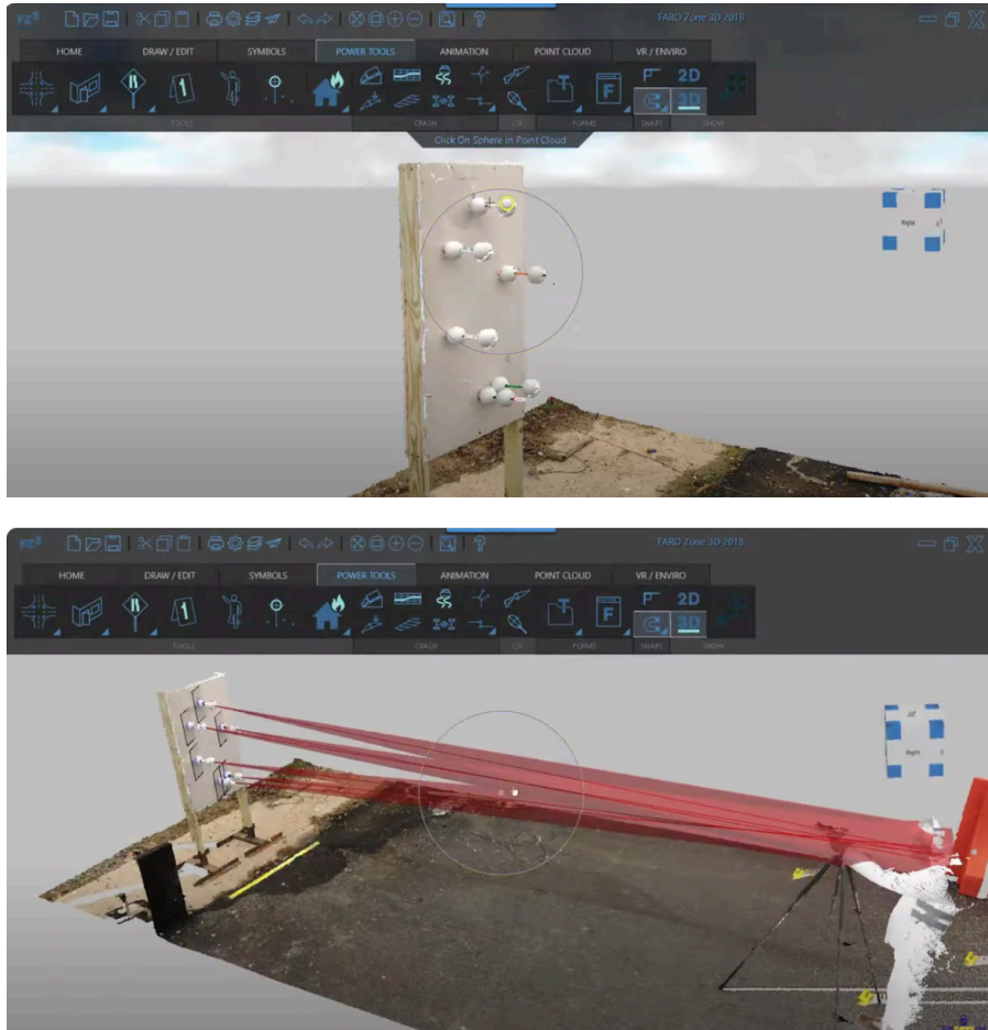
Şekil 1.23. FARO Zone 3D - Hata payı eklenmiş mermi yolu konileri (ScanTraining, 2018).
