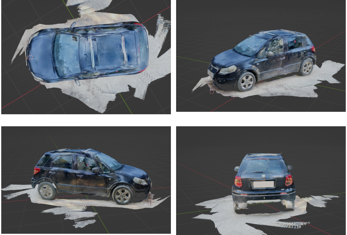
Şekil 3.5. 3D Scanner App 5mm hassasiyet ile dış mekan otomobil LiDAR tarama sonuçları
