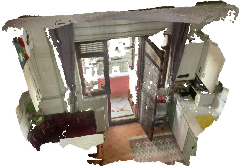
Şekil 3.15. Recon 3D iç mekan LiDAR taraması 2 (Tarama süresi: 30 sn, işleme süresi: 4 dk, 828.659 points)
