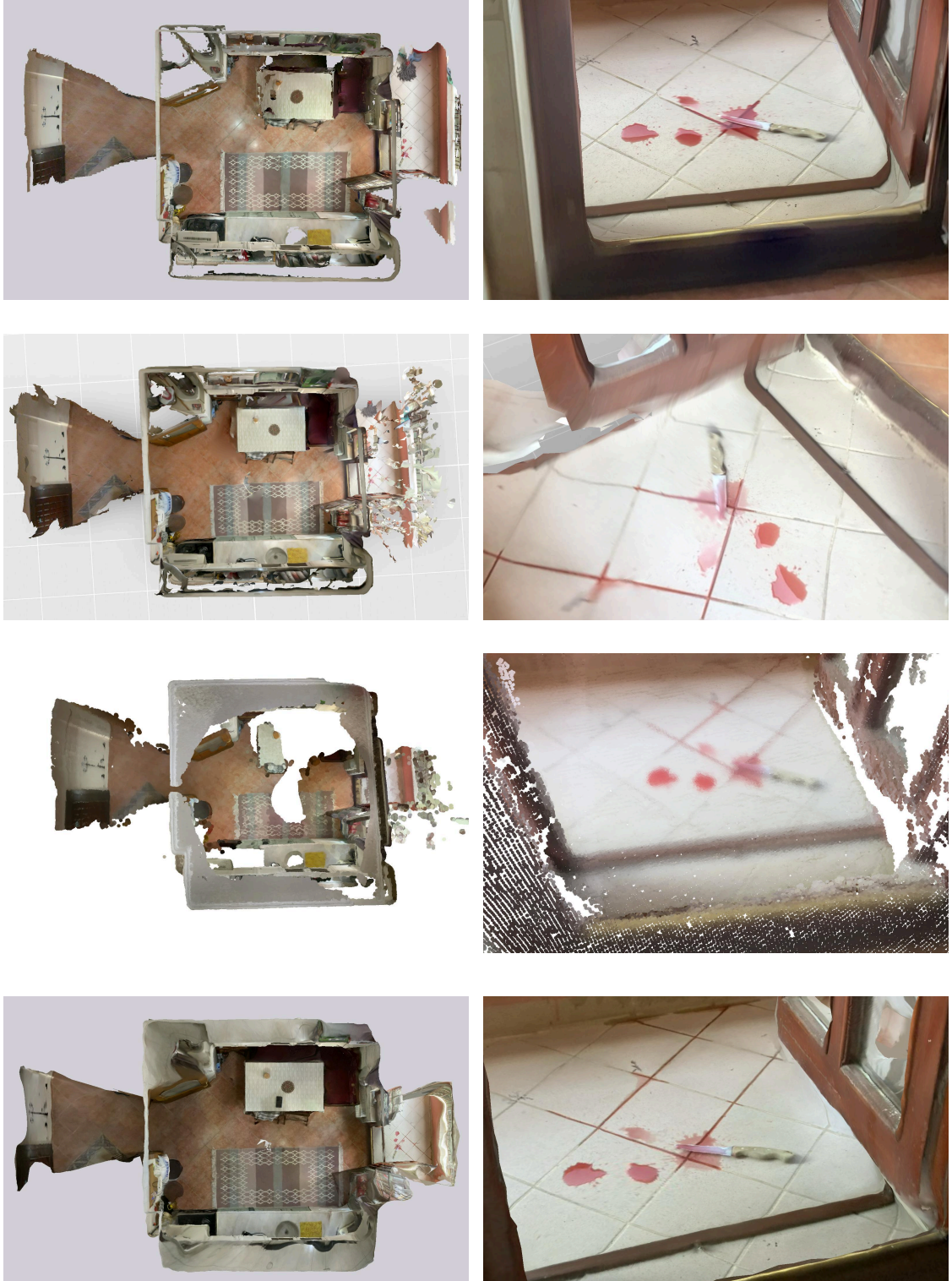
Şekil 3.18. 3D Scanner App-LiDAR (1. Sıra), MetaScan-LiDAR (2. Sıra), Recon3D-LiDAR (3. Sıra) ve 3D Scanner App-Photogrammetry (4. Sıra) geniş ölçekli iç mekan tarama sonuçları
