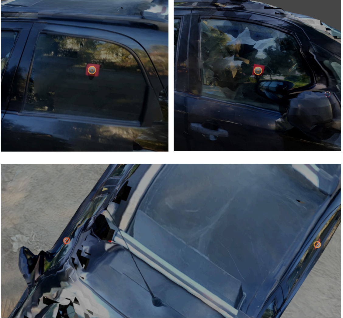
Şekil 3.23. Otomobilin sağ arka ve sol ön kapı camındaki temsili mermi giriş deliklerine yerleştirilen dijital küreler
