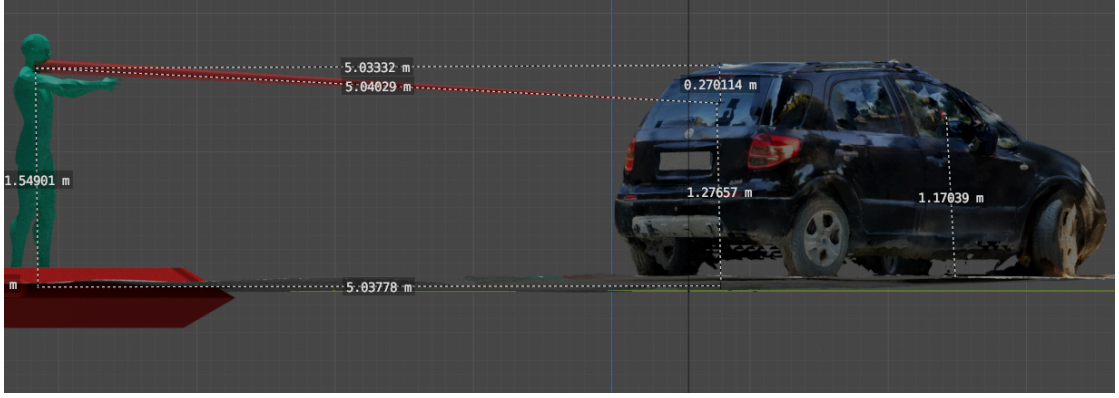
Şekil 3.34. Yeniden yapılandırma sonucunda atıcının X ekseninden görünümü
