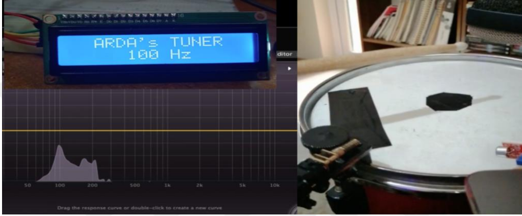
Şekil 12. Spectrum Analyser ile Doğrulama
