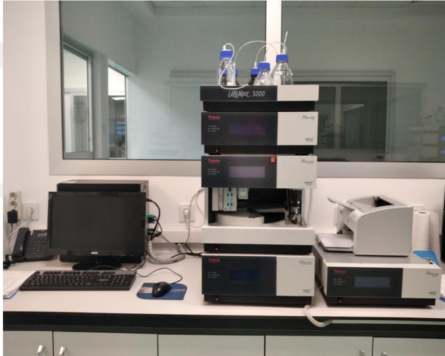
řekil 2.17. HPLC Cihazı, Dionex Ultimate 3000 (Zearalenon Analizi)
