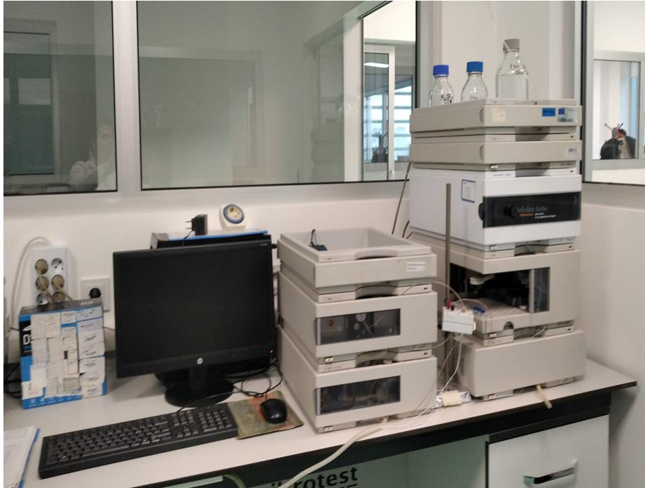
Şekil 2.18. HPLC Cihazı, Agilent 1100 (Deoksinivalenol Analizi)
