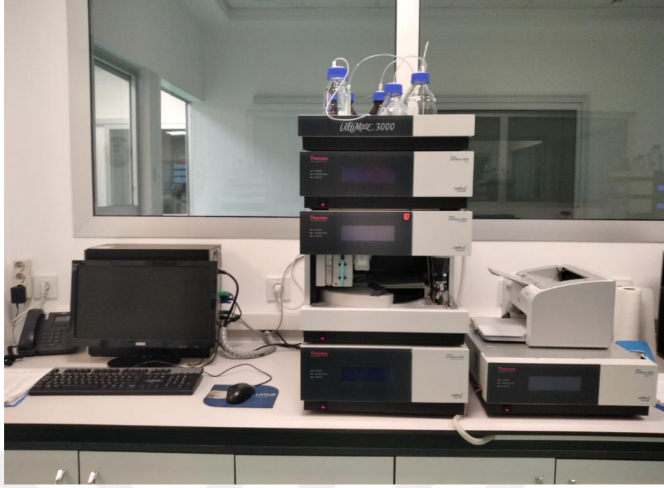
Şekil 2.19. HPLC Cihazı, Dionex Ultimate 3000 (Fumonisin Analizi)
