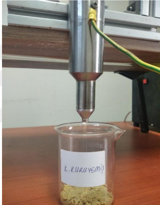
Şekil 2.6. Karışık kuruyemiş örneğinde soğuk plazma uygulaması
