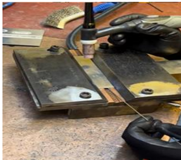
Şekil 4.2. Kök gazı kullanarak TIG kaynak yöntemi ile AW 6061 malzemenin birleştirme işlemi
