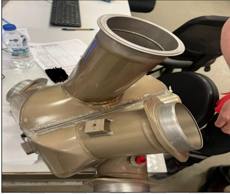
Şekil 3.11. Reheater üzerinde uygulanan kaynağın görüntüsü
