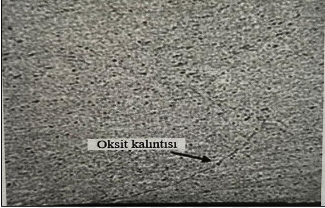
Şekil 3.9. Alüminyum alaşımlarının kaynağı sonrası oksit kalıntısı görüntüsü (Çam, 2020)
