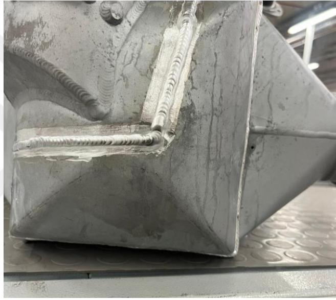
Şekil 3.10. Kondansatör üzerinde uygulanan kaynağın görüntüsü
