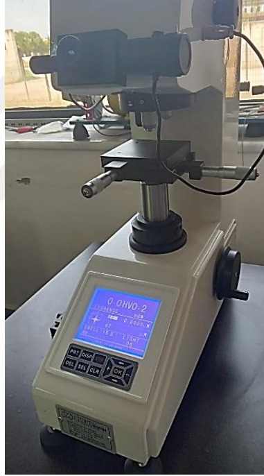
řekil 4.4. BMS Microbul 1000DN mikrosertlik test cihazı
