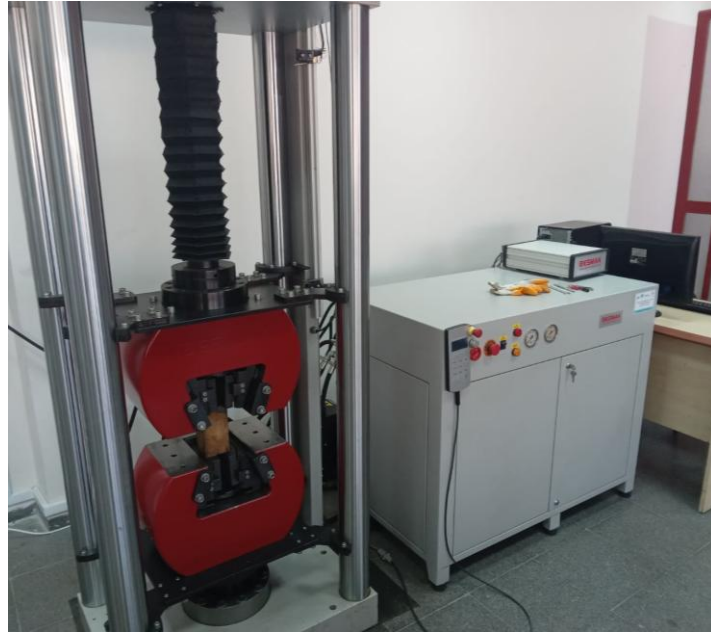
Şekil 4.6. BESMAK BMT-600S model servo hidrolik çekme test cihazı
