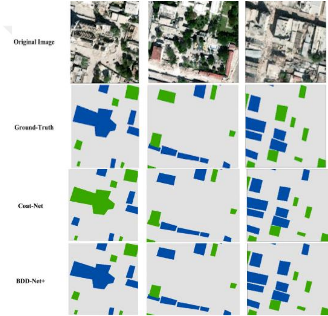
Şekil 3.30 : Önerilen BDD-Net+ ve Coat-Net yöntemlerinin gerçek durumla kıyaslaması.
