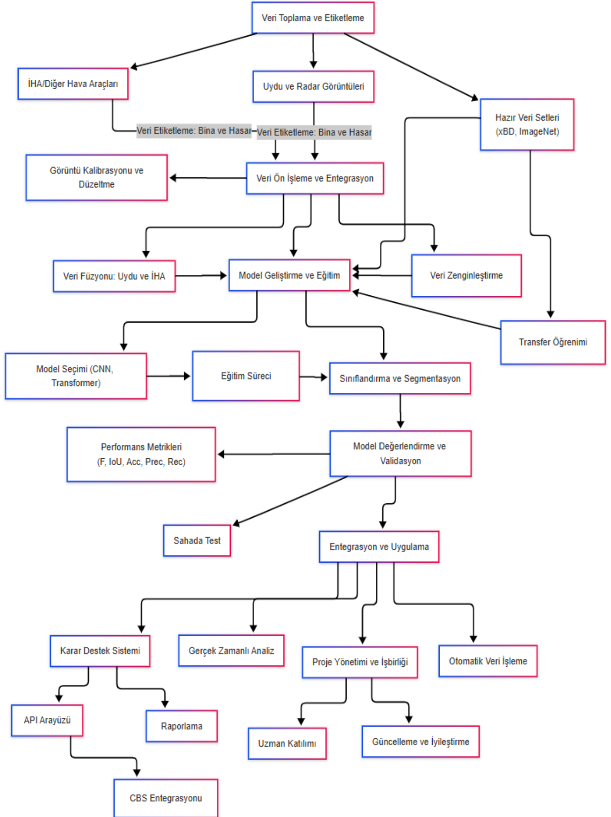
Şekil 4.1 : Afet sonrası bina hasar tespiti için yapay öğrenme işlemleri akış şeması.
