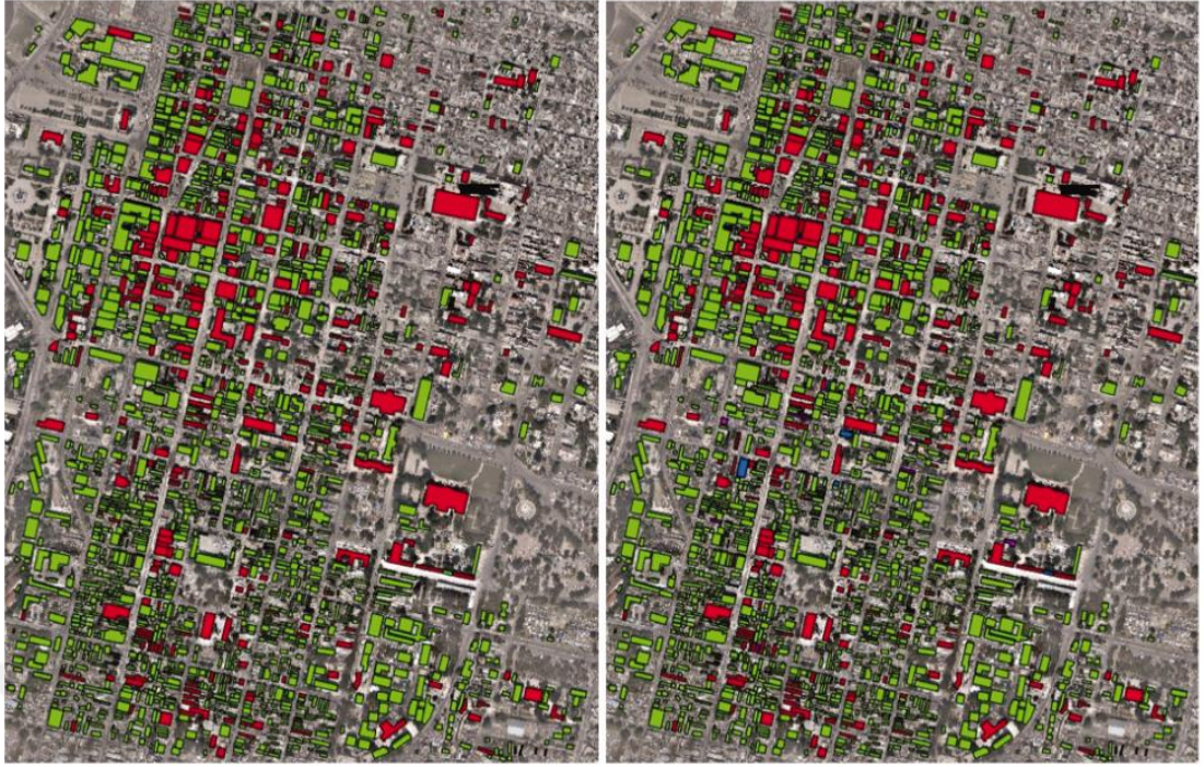
Şekil 3.28 : Gerçek durum ve uygulamanın hasar tespiti performans karşılaştırması.
