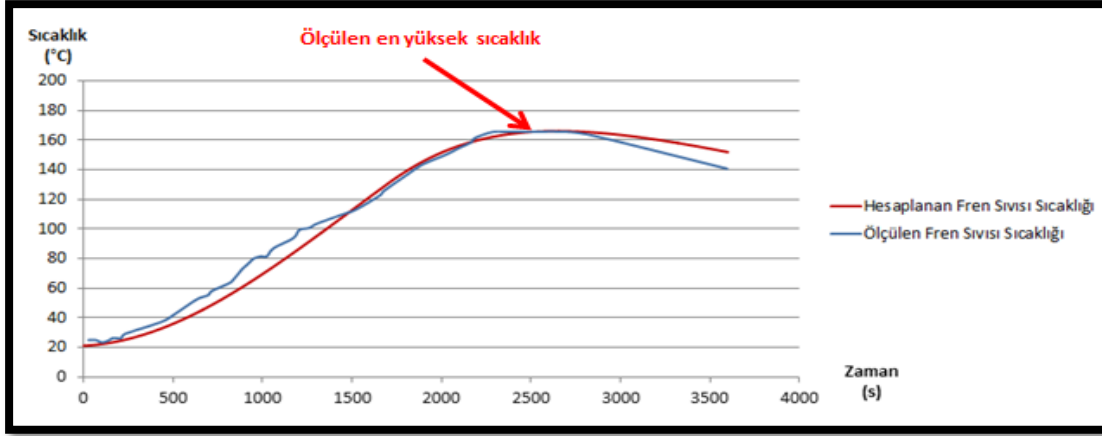
Şekil 8.10: Hesaplanan ve ölçülen fren sıvısı sıcaklıkları.
