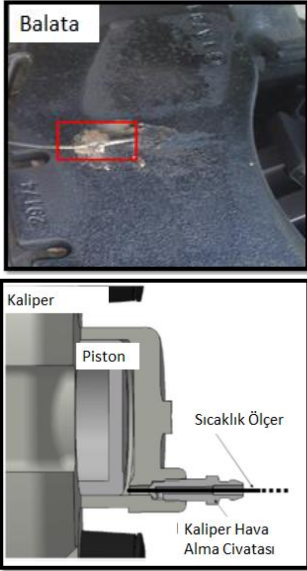
Şekil 7.5: Balata ve kaliper sıcaklık ölçer konumu.
