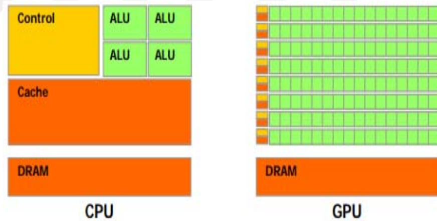
Şekil 2.1 CPU'nun donanımsal mimari karşılaştırması (NVIDIA, 2007)
