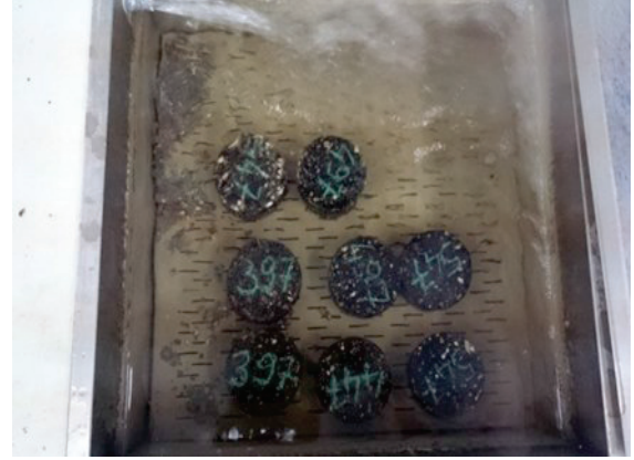
Şekil 50. NMS modifiye bitüm ile hazırlanan Superpave BSK numuneleri su banyosunda
