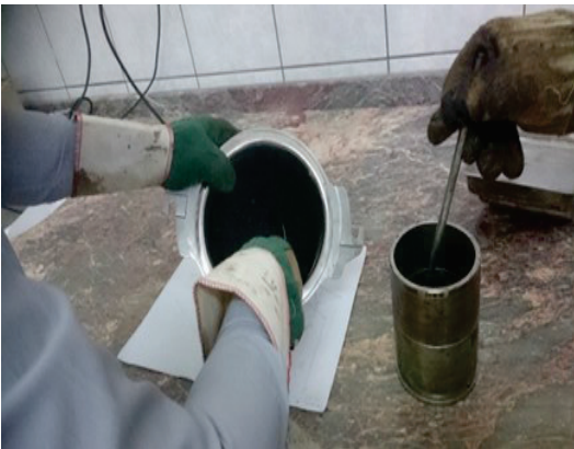
Şekil 35. BSK marshall numunelerinin hazırlanması
