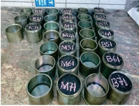
Şekil 39. Marshall deneyi düzeltme numuneleri
