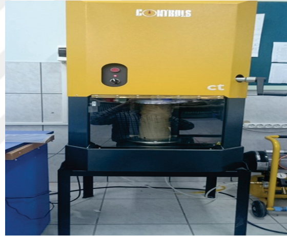
Şekil 46. Yoğurmalı sıkıştırıcı ile BSK numunesi hazırlanması
