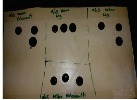
Şekil 26. %5 NK ve NMS yaşlandırılmamış DSR deney numuneleri
