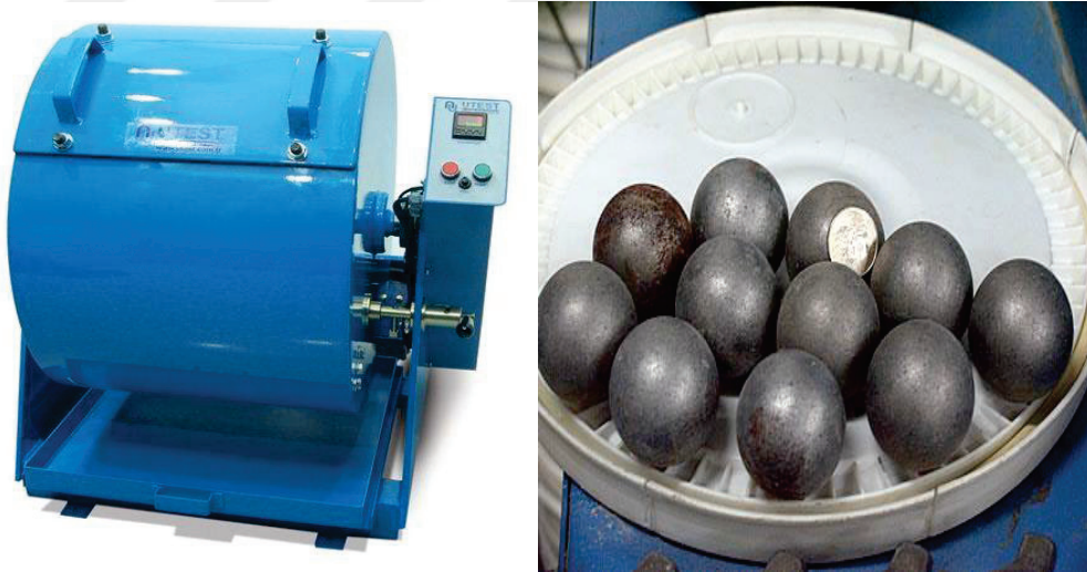
Şekil 3.3. (a) Los Angeles deney aleti (b) Kullanılan çelik bilyalar ( www.utest.com.tr )
