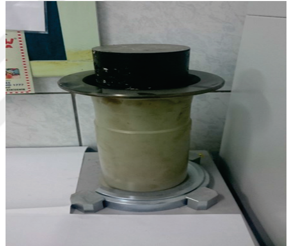
Şekil 52. Superpave BSK numunelerinin kalıptan çıkartılması
