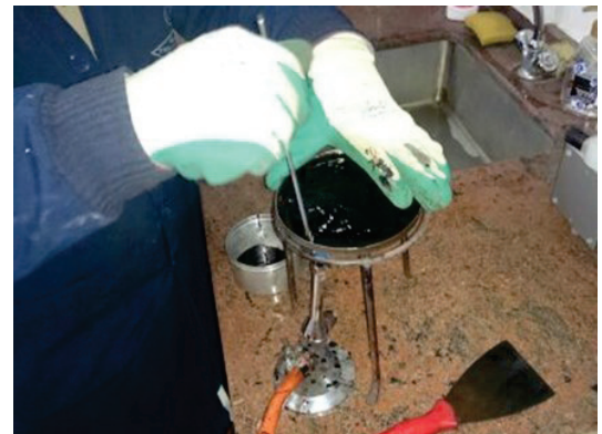
Şekil 18. PAV deneyinde numunenin vakum için hazırlanması
