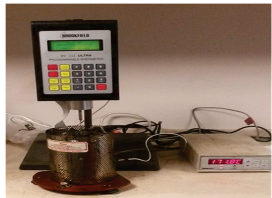
Şekil 6. Deneylerde kullanılan Brookfield viskozite cihazı
