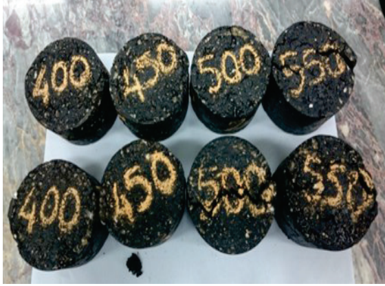
Şekil 49. Kontrol Superpave BSK numuneleri marshall stabilite deneyi sonrasında
