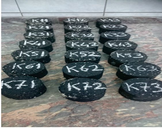
Şekil 37. Kontrol marshall deney numuneleri (21 adet)
