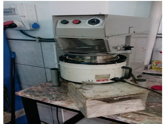
Şekil 36. BSK numunelerinin hazırlanmasında kullanılan ısıtıcı ve karıştırıcı
