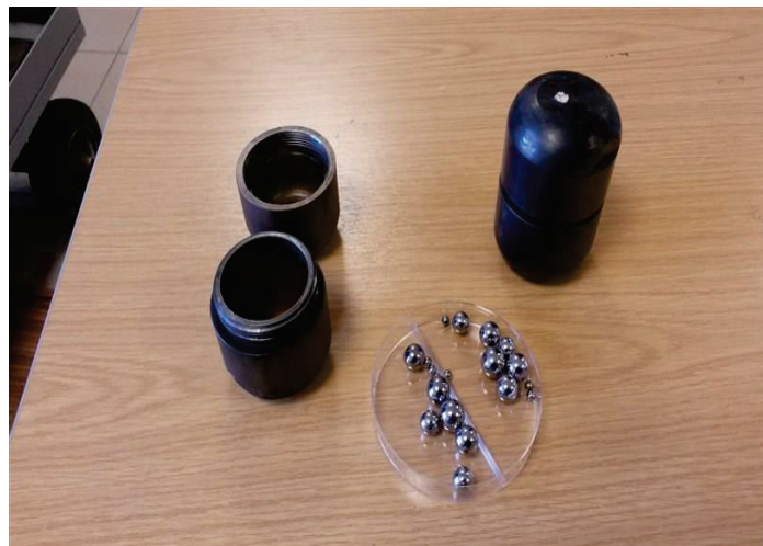
Şekil 7.3. Malzeme öğütmede kullanılan çelik reaktör ve muhtelif boyutta çelik bilyalar
