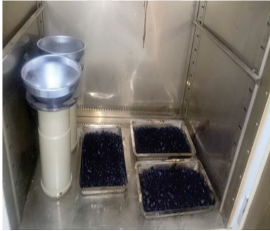
Şekil 45. Etüv içerisinde yaşlanmaya maruz bırakılmış Superpave BSK numuneleri
