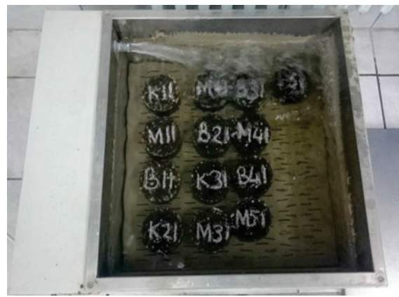
Şekil 42. Marshall düzeltme numuneleri su banyosunda
