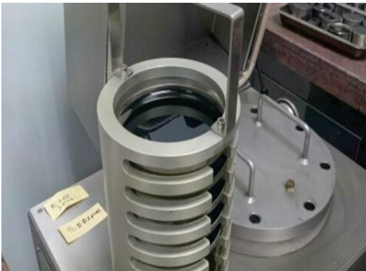
Şekil 17. PAV deney tavaları raflara yerleştirilmiş halde
