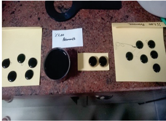
Şekil 3. Penetrasyon, yumuşama noktası, DSR deney numuneleri
