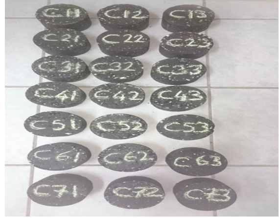
Şekil 38. NK modifiye marshall deney numuneleri (21 adet)
