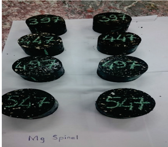
Şekil 51. NMS modifiye bitüm ile hazırlanmış Superpave BSK numuneleri (8 adet)
