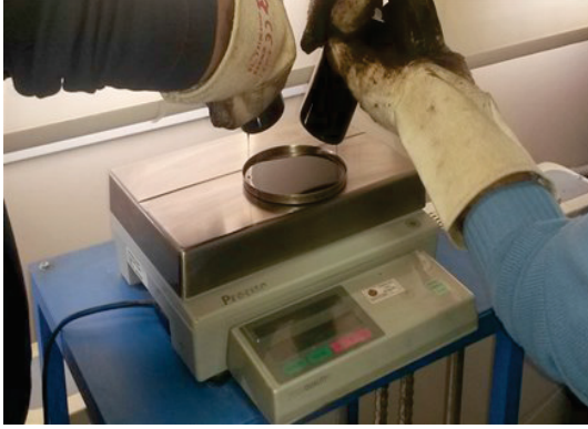
Şekil 13. RTFOT sonrası numunelerin PAV tepsilerine aktarılması
