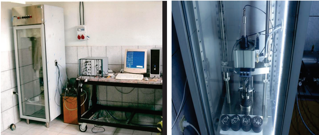
Şekil 3.14. (a) Sünme cihazı, komprasör ve bilgisayar (b) Yükleme çerçevesi
