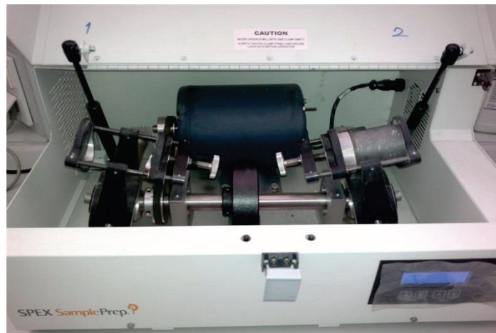
Şekil 7.1. 3 boyutlu Spex çalkalama cihazı (Eti Maden laboratuvarı)
