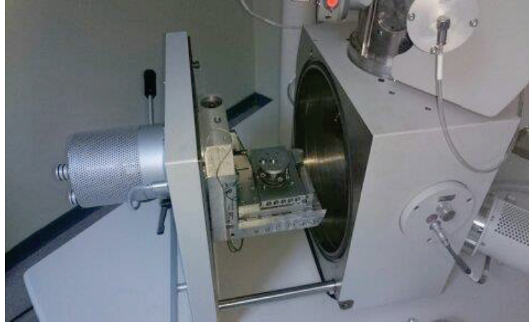
Şekil 7.5. EDS ve SEM analiz cihazı (UNAM)
