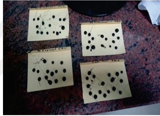
Şekil 28. Uzun dönem yaşlandırılmış DSR deney numuneleri
