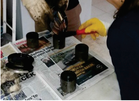
Şekil 21. PAV deneyi vakum için numunelerin kaplara doldurulması
