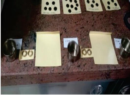
Şekil 1. Penetrasyon ve yumuşama noktası deneyi
