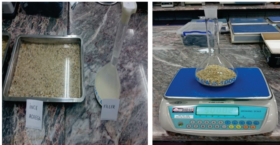
Şekil 3.5. (a) İnce agrega numunesi suda bekletilmesi (b) Piknometre ile tartım
