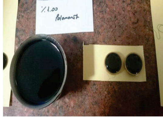
Şekil 2. %1 NK Penetrasyon ve yumuşama noktası deneyi
