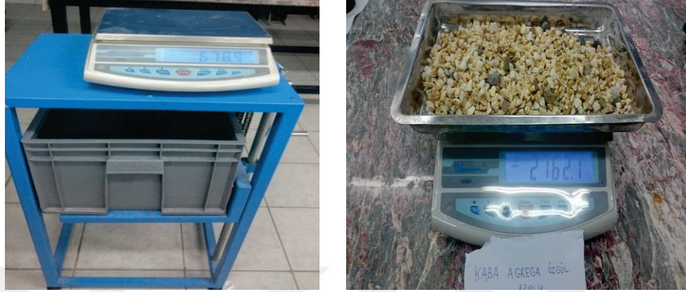
Şekil 3.4. (a) İri agrega özgül ağırlık deney düzeneği (b) Doymun yüzey numune tartımı
