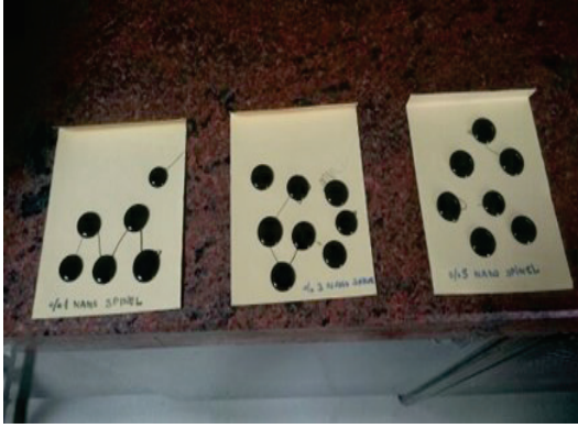
Şekil 25. Yaşlandırılmamış DSR deney numuneleri
