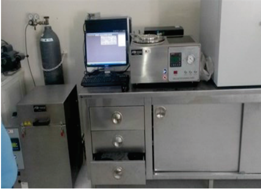
Şekil 15. Karayolları 2'nci Bölge Müdürlüğü PAV cihazı
