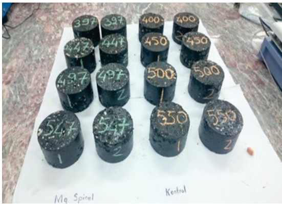
Şekil 47. Normal ve NMS modifiye bitüm ile hazırlanmış Superpave BSK numuneleri (16 adet)
