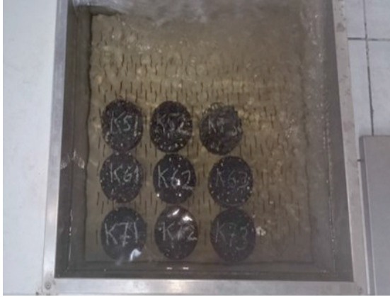
Şekil 43. Marshall kontrol numuneleri su banyosunda
