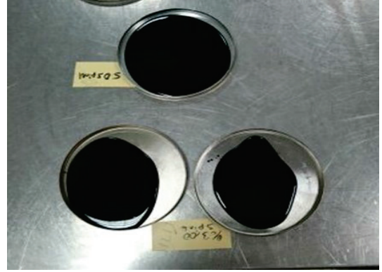
Şekil 14. %3 ve %5 NMS numuneleri PAV deneyinde
