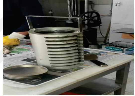
Şekil 16. PAV deney tavalarının raflara yerleştirilmesi
