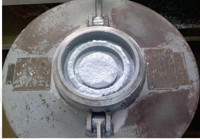
Şekil 7.2. Tablalı öğütme cihazı (Eti Maden işletmeleri laboratuvarı)
