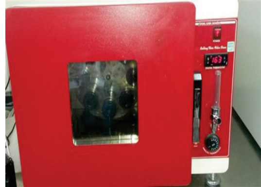
Şekil 8. Deneylerde kullanılan RTFOT deney cihazı
