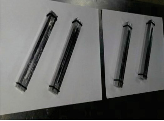
Şekil 31. Yağlanarak döküme hazır hale getirilmiş BBR deney kirişleri
