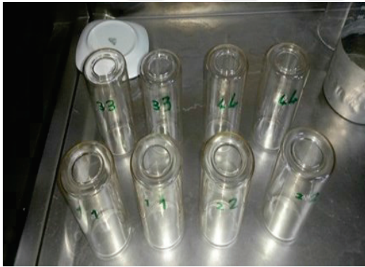
Şekil 9. RTPOT deney tüplerinin hazırlanması
