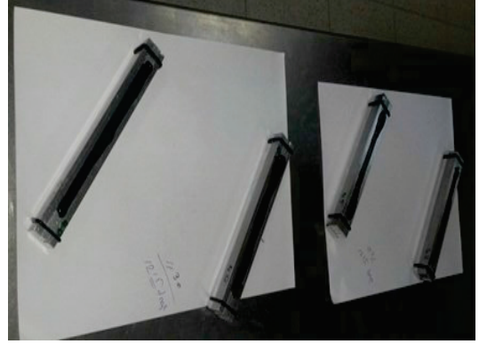
Şekil 32. Bitüm ile doldurulmuş BBR deney kirişleri
