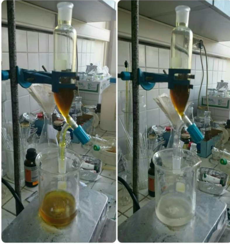
Şekil 3.2: PDMS-ThC-b-PPy kopolimerinin \text{FeCl}_3 ile kimyasal oksidatif polimerizasyonu
