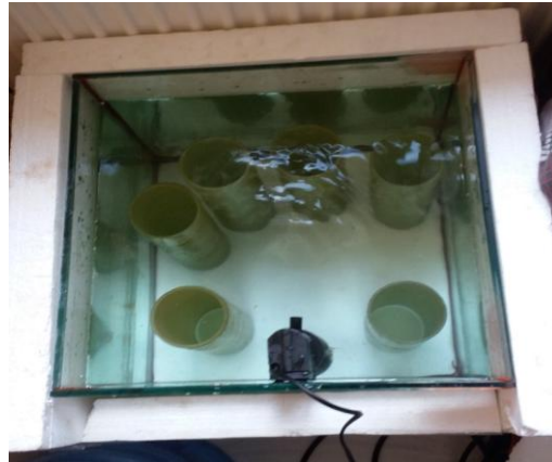
Şekil 4.2. Hidrotermal yaşlandırma ünitesi
