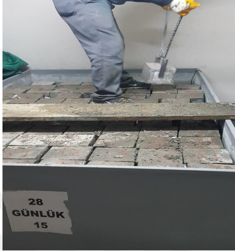
Şekil 3.9: 28 Günlük bekletme havuzu.
