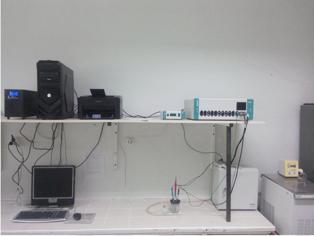
Şekil 2.1 Ölçüm düzeneği. (Üst sıra, soldan sağa: Güç kaynağı, bilgisayar, yazıcı, karıştırıcı, potansiyostat/galvanostat. Alt sıra, soldan sağa: Monitör, ölçüm hücresi ve elektrotlar, soğutmalı su sirkülatörü)
