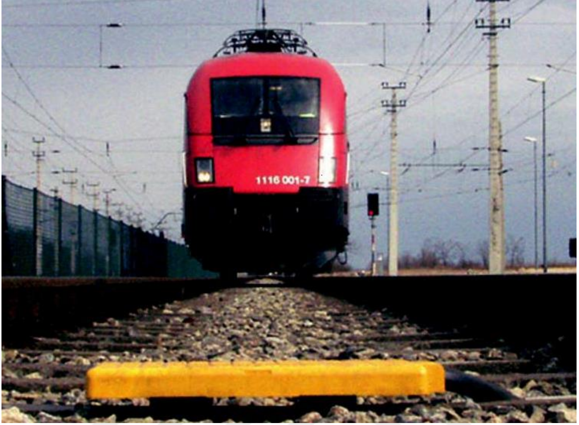
Şekil 4.8. Programlanabilir eurobaliz (Siemens, 2014)
