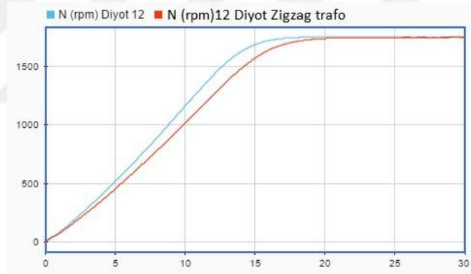
Şekil 5.24: Zigzag trafo kullanıldığında devir sayısı zaman grafiği.
