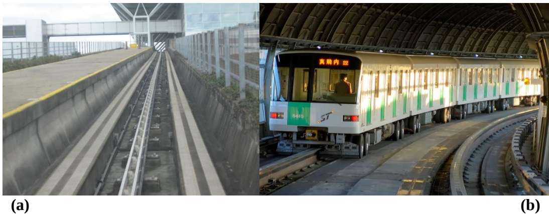
Şekil 2.42: (a) ve (b) Rayların ortasına kurulan bir üçüncü ray sistemi.
