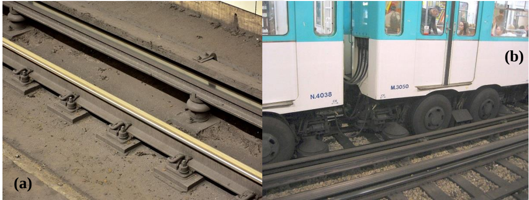
Şekil 2.41: (a) ve (b) Rayların yanına kurulan bir üçüncü ray sistemi.
