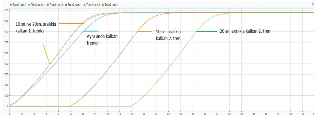
Şekil 5.46: Aynı anda, 10 saniye aralık ile ve 20 saniye aralık ile kalkış yapan trenlerin motorlarının devir sayısı zaman grafiği.
