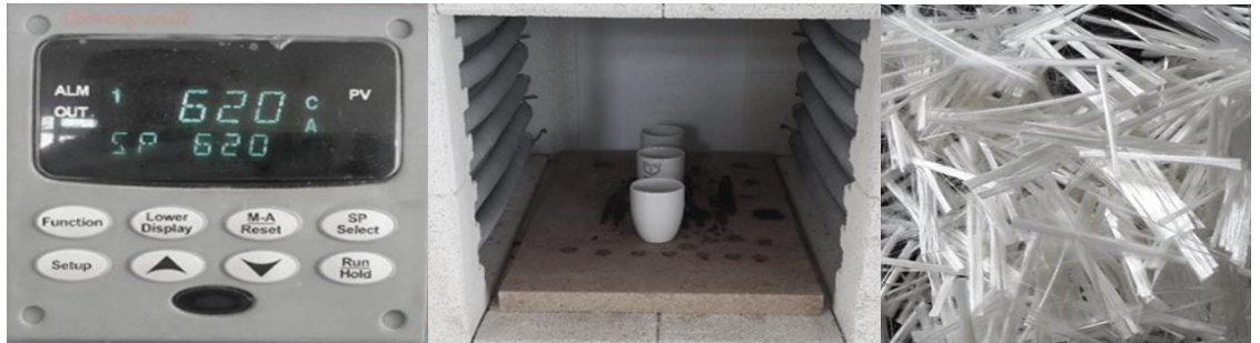
Şekil 6.1. Kül fırını ayar ekranı(620 0 C'de), numune kapları fırın içi pozisyonu, reçinesi uzaklaştırılmış elyaflar (soldan sağa)
