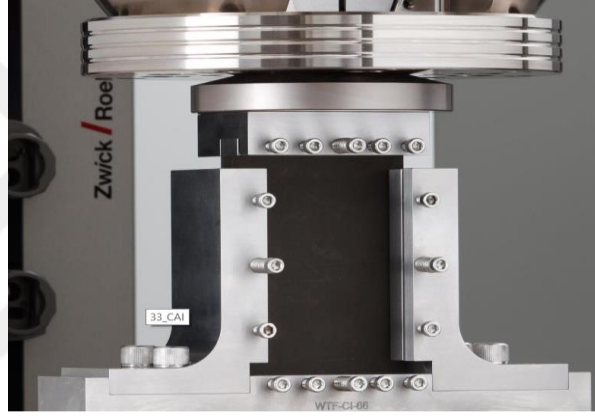
Şekil 5.4. ISO, EN ve Airbus standartlarına ait basma aparatı https://www.zwick.com/
