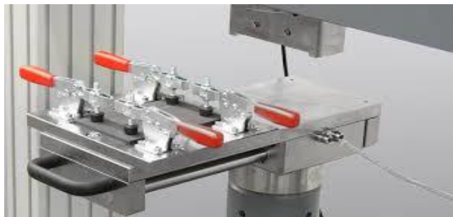
Şekil 5.3. Darbe testi numune yerleştirme bölgesi (numune tutucular) ( https://www.zwick.com/ )
