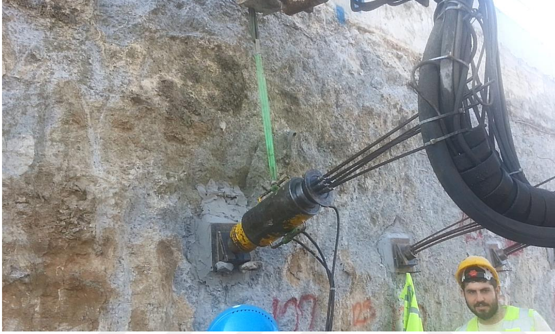
Şekil 3.6 : Öngermeli ankraj testi.
