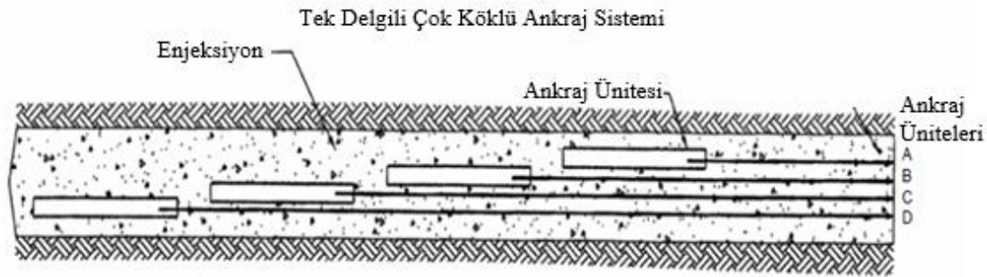
Şekil 4.2 : Tek delgili çok köklü ankrajların tip kesiti.
