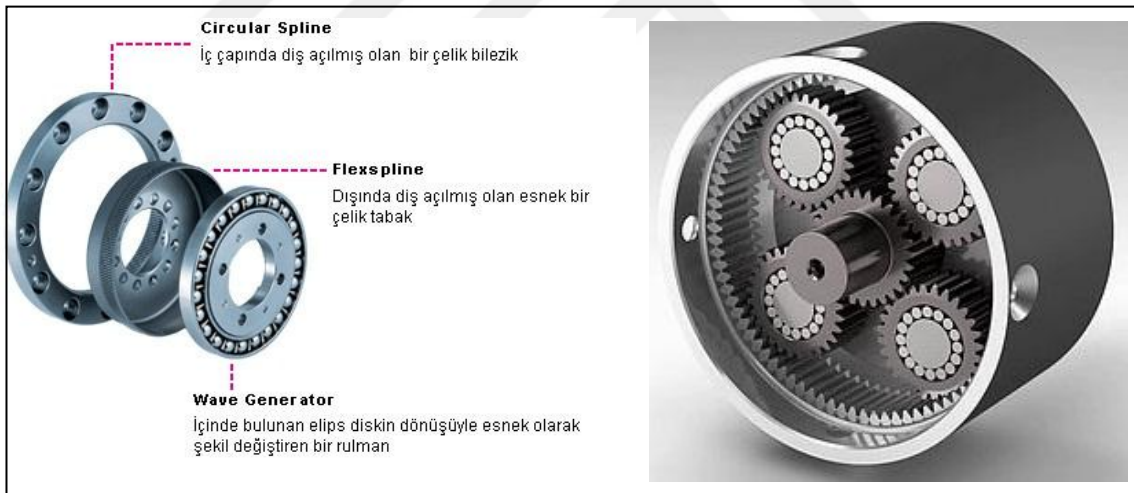
Şekil 3.4 Harmonik drive ve planet redüktör yapısı [14]
