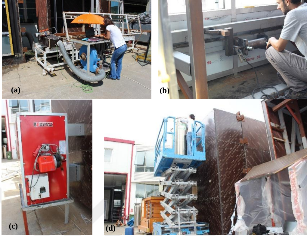
Şekil 4.2 Hava ve su sızdırmazlık testi için basınç oluşturma düzeneği (a), Deprem testinde kullanılan özel piston (b), Mazotlu ısıtıcı (c), Sıvı azot tüpleri (d).
