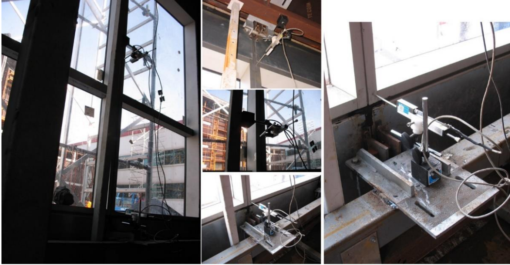
Şekil 4.7 Panel sistem ölçüm sensörlerinin yerleşimi.
