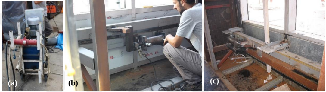
Şekil 4.12 Deprem testinde kullanılan cihazlar (a), Deprem testinin uygulanması çubuk sistem (b) ve panel sistem (c).
