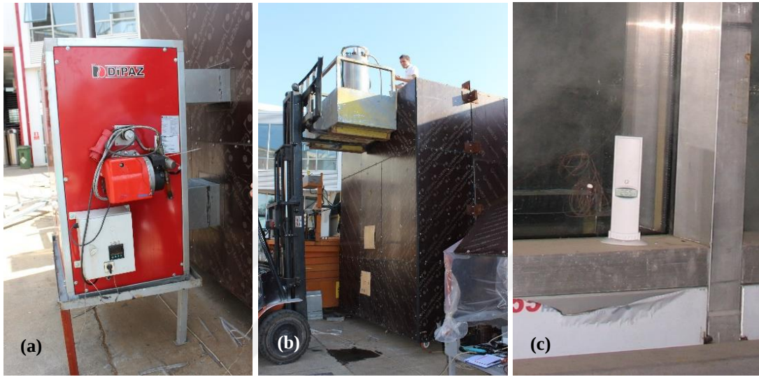
Şekil 4.18 Test boyunca kullanılan cihazlar mazotlu ısıtıcı (a), sıvı azot tüpü (b), nemölçer (c).
