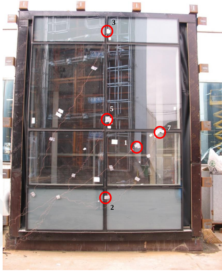
Şekil 4.16 Panel sistemde dış ortamda bulunan sıcaklık ölçerler.
