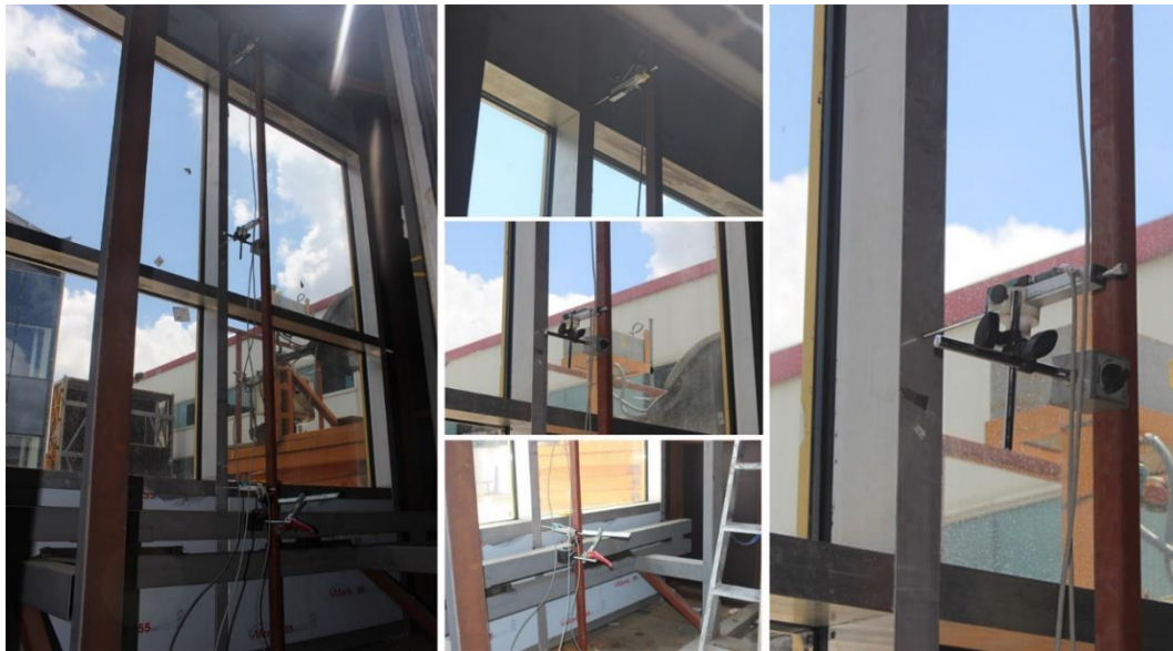
Şekil 4.6 Çubuk sistem ölçüm sensörlerinin yerleşimi.
