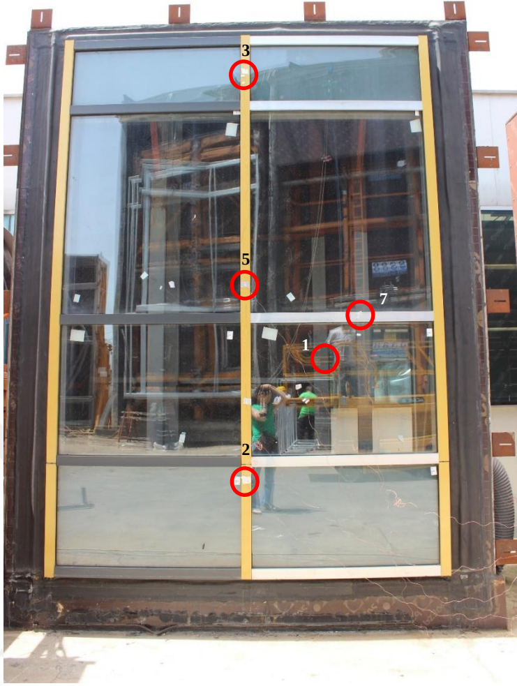
Şekil 4.14 Çubuk sistemde dış ortamda bulunan sıcaklık ölçerler.
