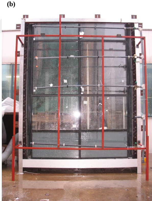
Şekil 4.9 Numunelerinin güvenlik yükü testi sonrası durumu çubuk (a), panel (b).
