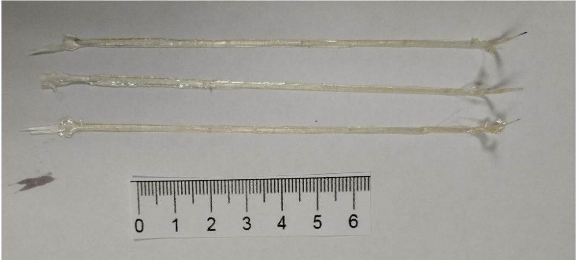
Şekil 32. 600 mm/dak ilerleme hızıyla elde edilen kompozit lif numuneleri
