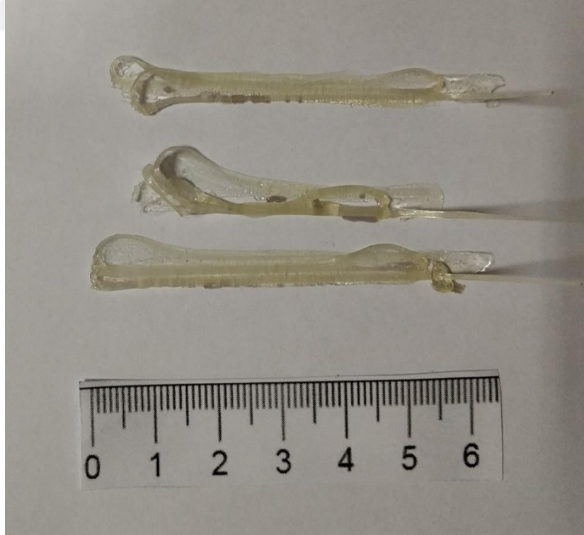
Şekil 46. 1 mm yanıl istif mesafesiyle, 675 mm/dak ilerleme hızıyla yığılan numuneler
