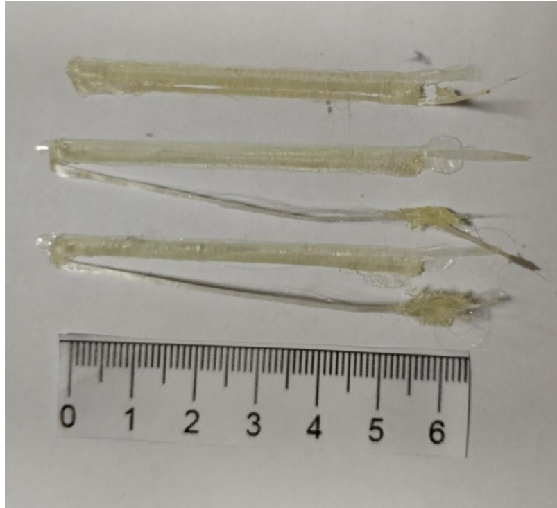
Şekil 43. 1 mm yanal istif mesafesiyle, 525 mm/dak ilerleme hızıyla yığılan numuneler
