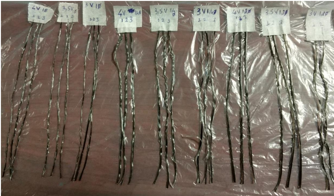
Şekil 24. Karbon fiberle elde edilen kompozit lifler
