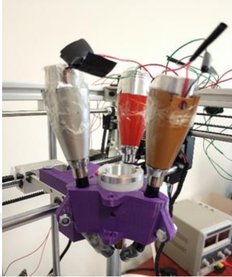
Şekil 19. Nozul ve Led lamba montajı
