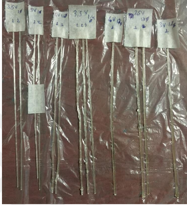
Şekil 26. Cam fiberle kompozit numuneler
