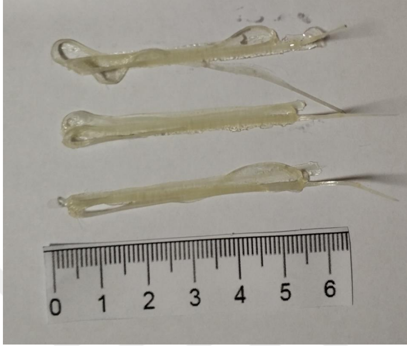
Şekil 45. 0.75 mm yanıl istif mesafesiyle, 675 mm/dak ilerleme hızıyla yığılan numuneler
