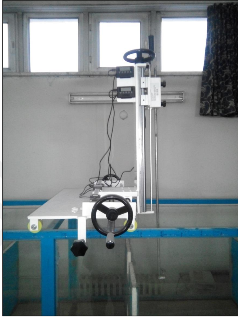
Şekil 2.17. 3 Boyutlu Ölçüm Almayı Sağlayan Hareketli Sistem
