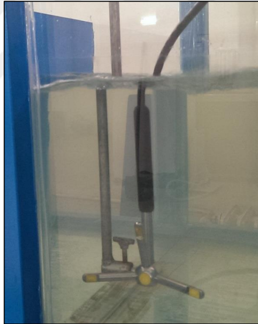
Şekil 2.16. ADV Hız Ölçüm Sensörü
