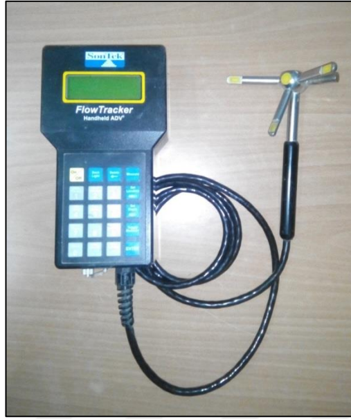
Şekil 2.15. ADV (Acoustic Doppler Velocimeter) Cihazı
