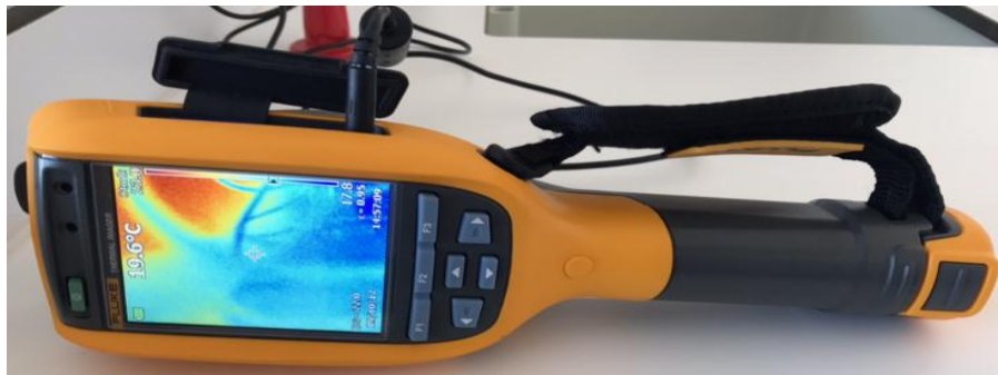
Şekil 3.18 Yüzey sıcaklığını ölçmek için kullanılan kızılötesi kamera
