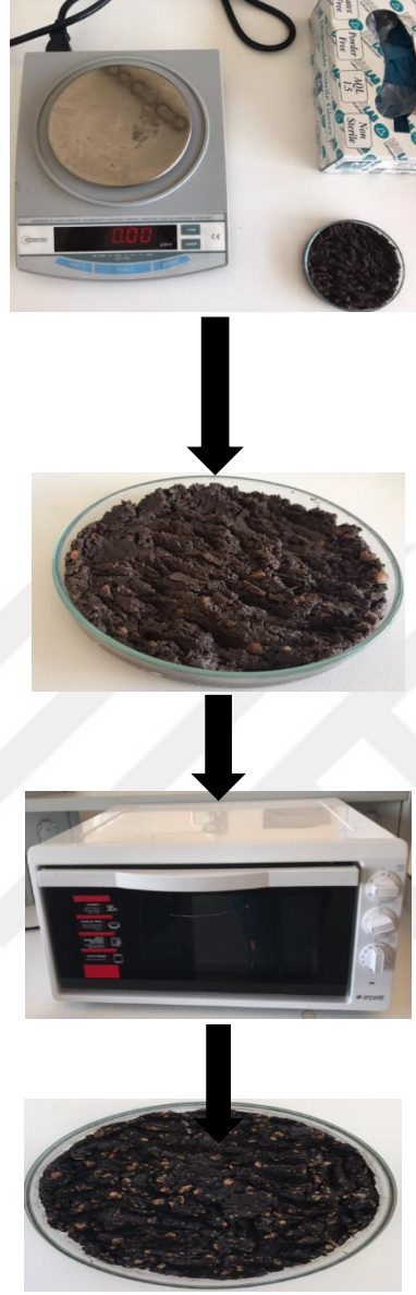
Şekil 3.1 Pirina örneklerinin kurutma işlemi aşamaları
