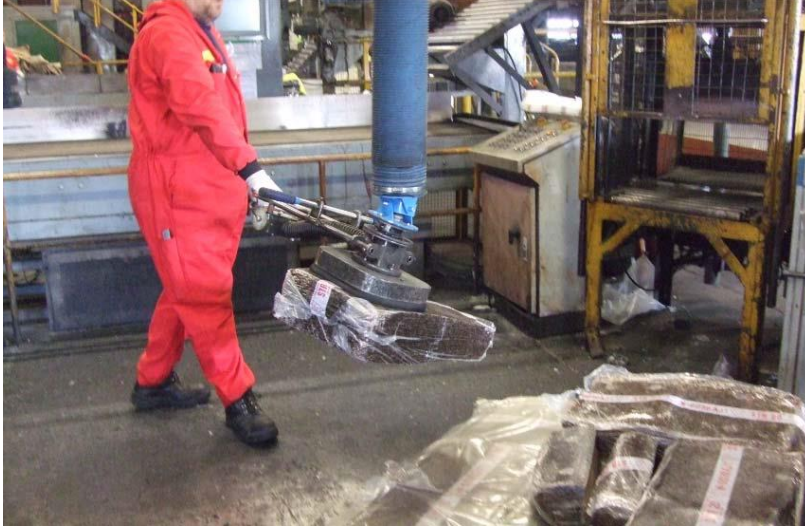
Resim 3.2. Balyaların vakum ile taşınması
