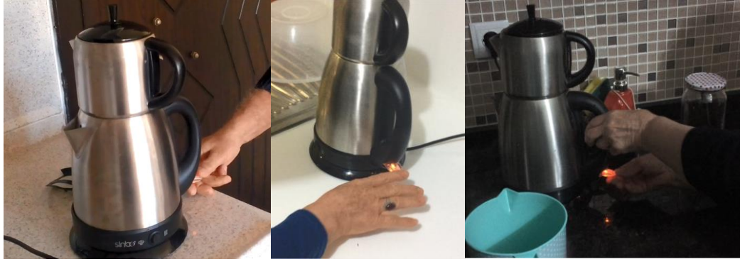
Şekil 6.8 : Kullanıcıların çalıştırma görevi sırasında yanlış tuşa basması.
