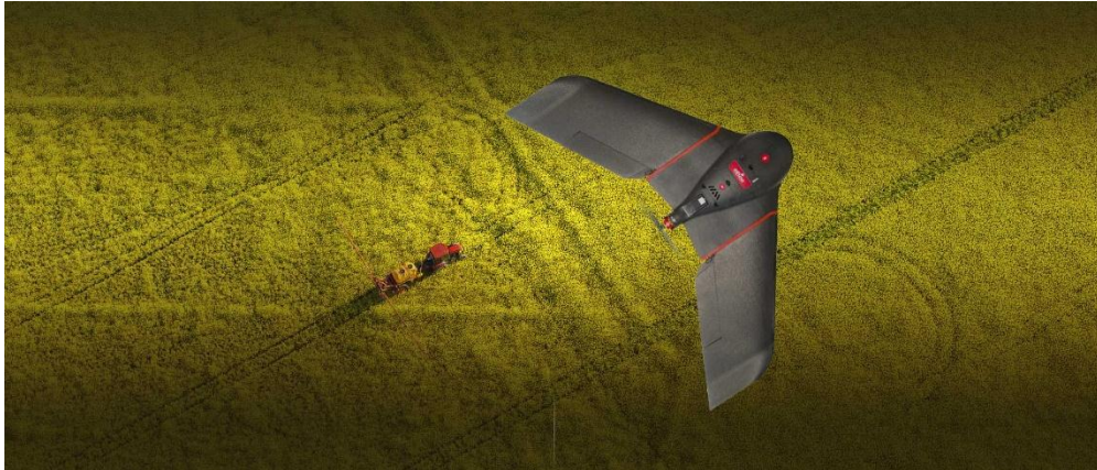
Şekil 3.7. İHA - Kanatlı (SenseFly ebee)
