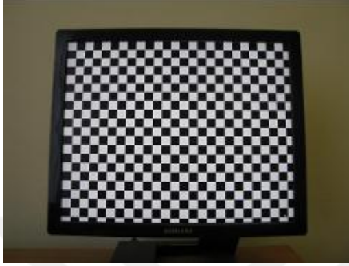
Şekil 3.13. Bilgisayar ekranında görüntülenen kalibrasyon deseni
