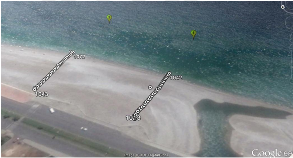
Şekil 3.41. GPS ile boyuna profil Google Earth görünümü
