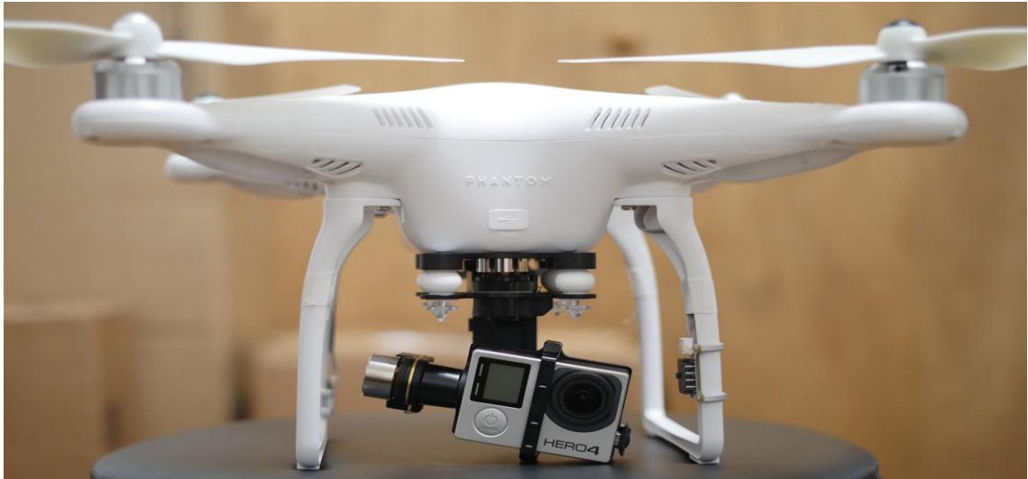
Şekil 3.8. İHA - Multikopter (DJI Phantom 2 V2)
