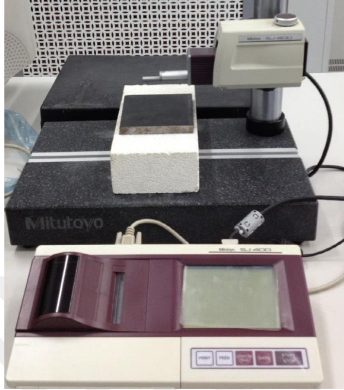
Şekil 5.14 Mitutoyo SJ-400 yüzey profili ölçüm cihazı.
