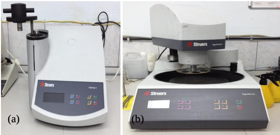
Şekil 5.9 (a) Struers CitoPress-1 kalıplama ve (b) Struers Tegra Pol-21 zımparalama-parlatma cihazları.
