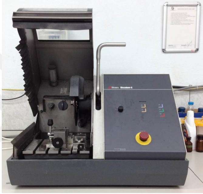
Şekil 5.2 Struers Discotom-5 kesme cihazı.
