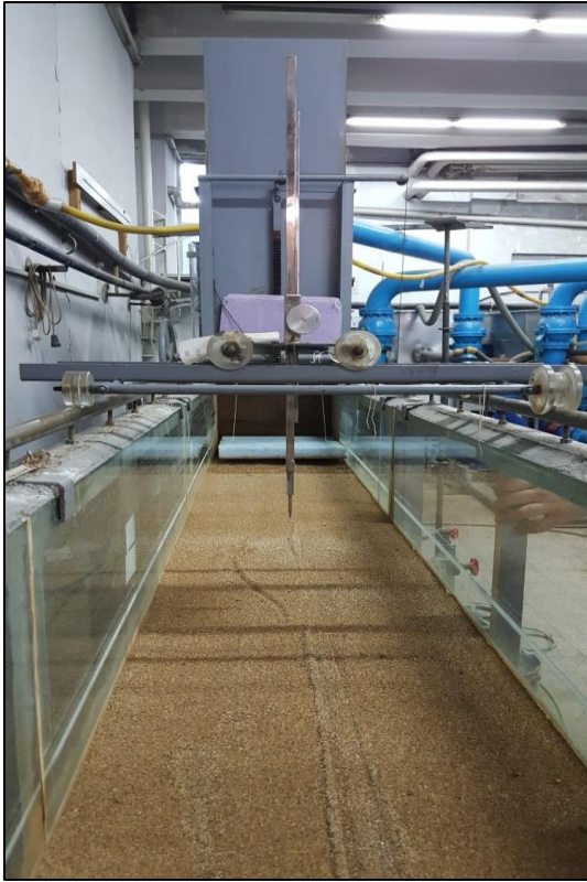
Resim 4.2. İğne uçlu limnimetre
