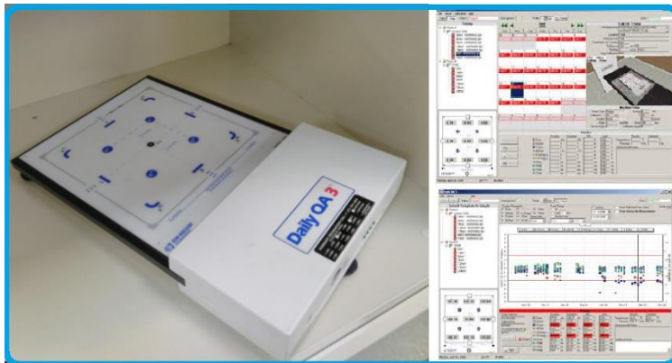
Şekil 3.15 Daily QA günlük mekanik ve dozimetrik kontrol sistemi
