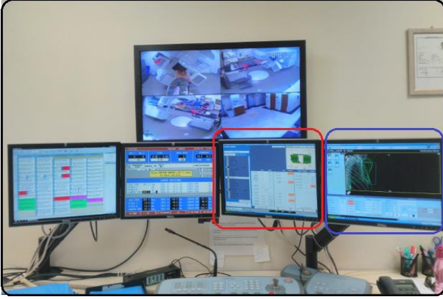
Şekil 3.12 Kumanda odası kontrol sistemleri (kırmızı çerçeve 4DTCI, mavi çerçeve OBI ekranları ve üstte hasta takip kameraları)
