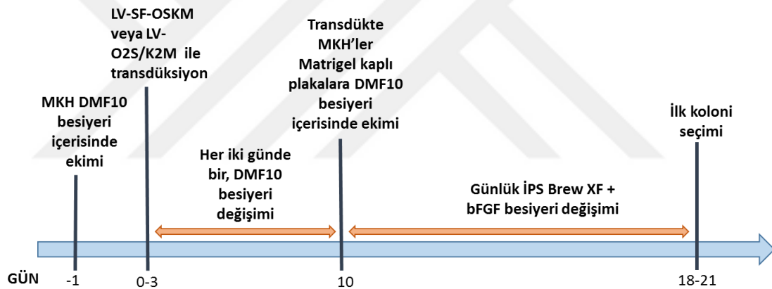
Şekil 3.12. MKH'lerin LV-SF-OSKM veya LV-O2S/K2M ile yeniden programlama süreci
