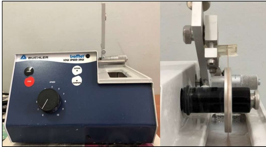
Şekil 2.7. Otolit kesit makinesi ve kesit alma işlemi
