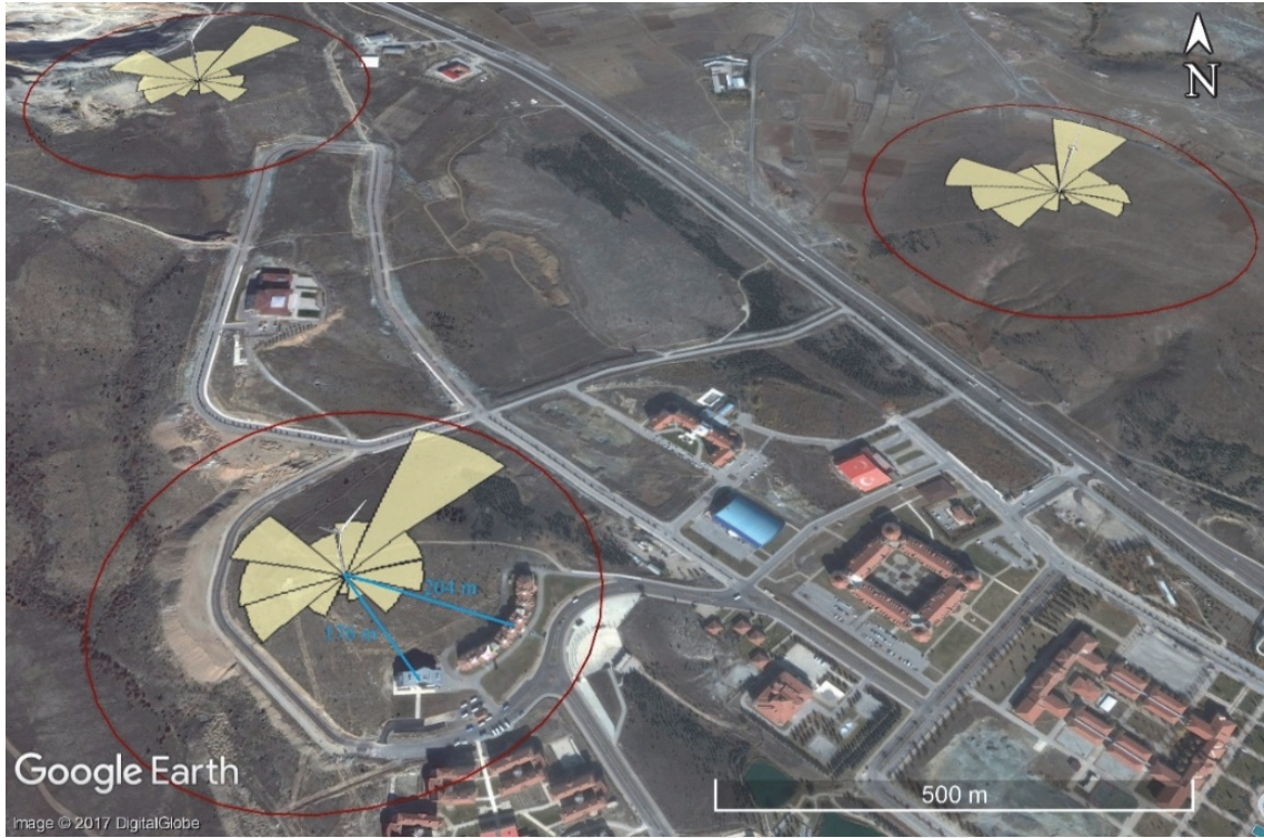
Şekil 5.20. Belirlenen sahalar üzerinde Model-100/1 modelinin yakın iz bölgesi ve yönleri göre yıllık enerji üretiminin dağılımı.
