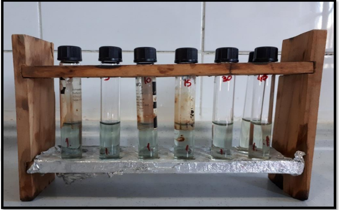
Şekil 3.7. TF Kalibrasyon eğrisi hazırlamak için kullanılan seri çözeltiler
