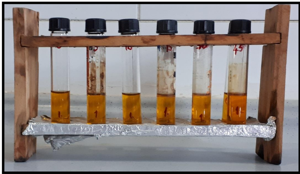
Şekil 3.5. KOİ kalibrasyon eğrisi hazırlamak için kullanılan seri çözeltiler
