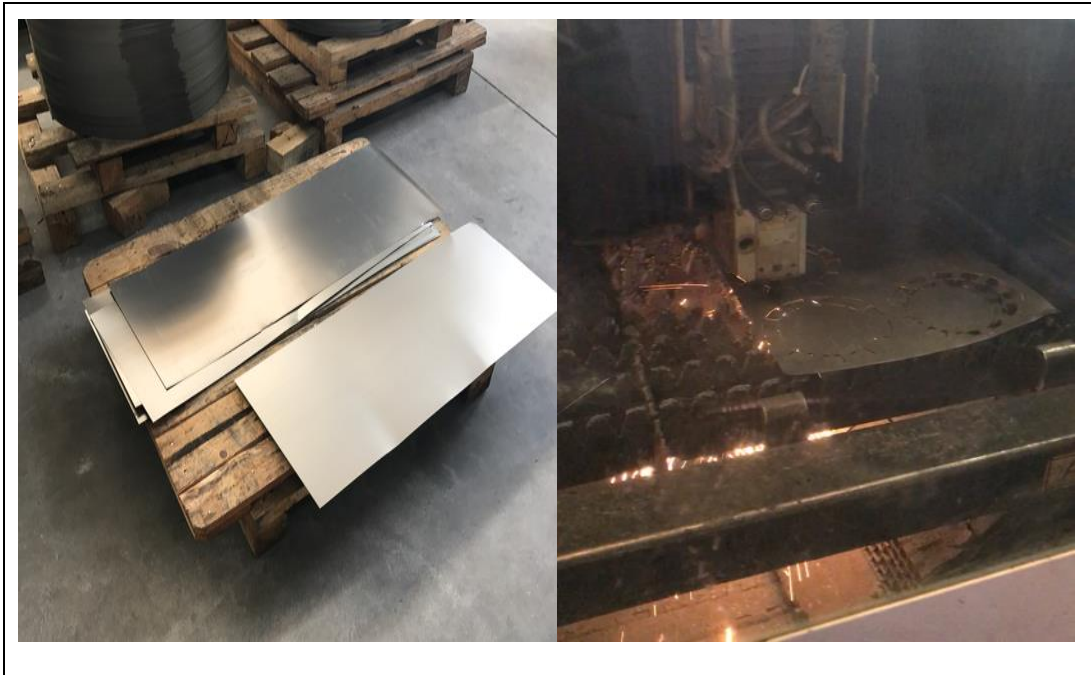
Şekil 6.9 Saçların lazer kesimi
