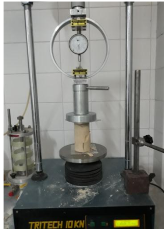
Fotoğraf 5.10. Tek eksenli basınç deneylerinin gerçekleştirilmesi
