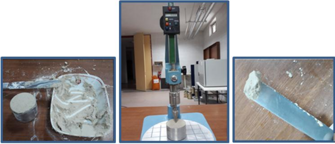
Fotoğraf 5.3. Numunenin deney aletine yerleştirilmesi
