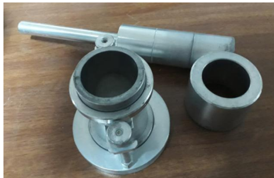
Fotoğraf 5.7. 50 mm çapında 100 mm yüksekliğindeki çelik silindirik numune hazırlayıcı kalıp
