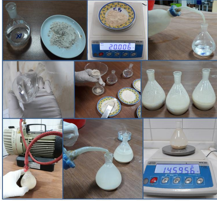
Fotoğraf 5.5. Piknometre deney aşamaları
