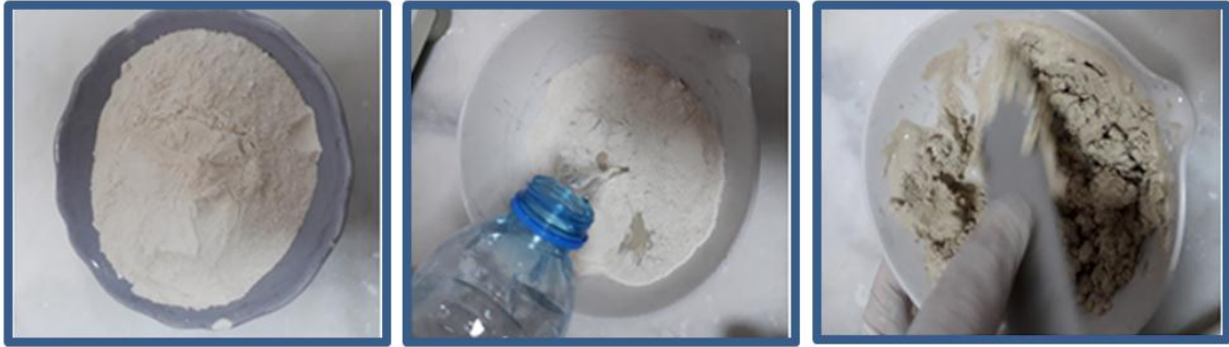
Fotoğraf 5.2. Etüvde kurutulan numuneye su eklenmesi
