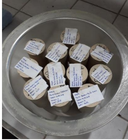
Fotoğraf 5.11. Küre bırakılan serbest basınç numuneleri
