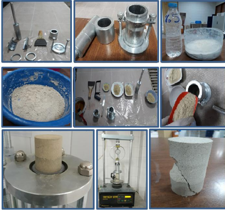
Fotoğraf 5.8. Serbest basınç deney aşamaları
