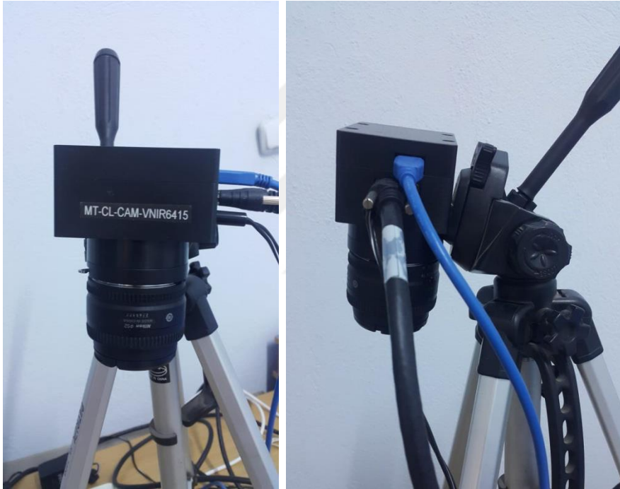
Şekil 3.2. Çalışmada kullanılmış olan VNIR Kamera
