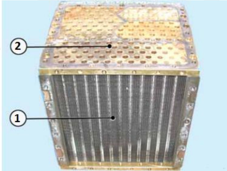
Şekil 3.8: İntercooler lamelleri ve boruları. (1-lameller, 2-bakır borular)
