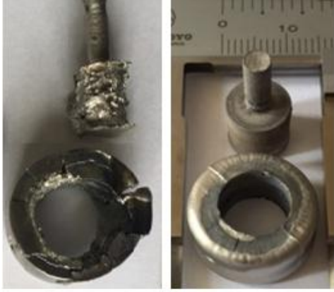
Resim 5.1. Ön deneylerde sinterlenen HSS/WC-Co numuneler a) 1300 °C'de sinterlenen b) 1250 °C'de sinterlenen
