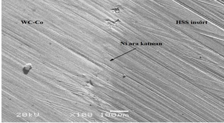
Şekil 5.3. Ni ara katman ve HSS insört kullanılarak üretilen numunenin ara bölgesi (1200 °C 240 dakika sinterleme)
