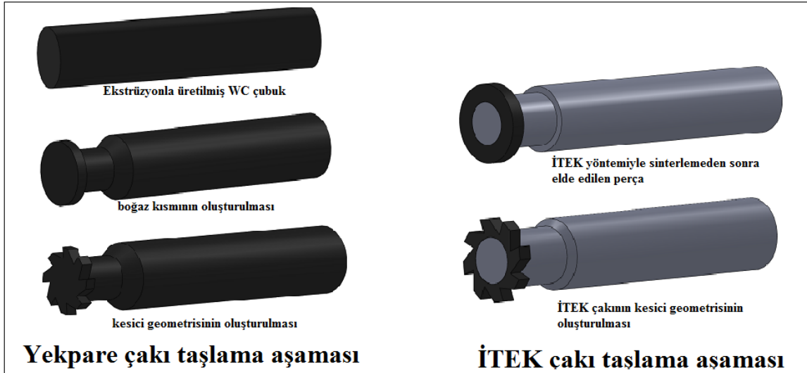
Şekil 5.36. Yekpare karbür ve İTEK çakıların taşlama aşaması
