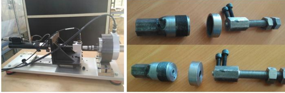
Resim 4. 9. Burulma deney cihazı ve deney sonrası kırılmış numunenin kalıp içerisindeki görüntüsü
