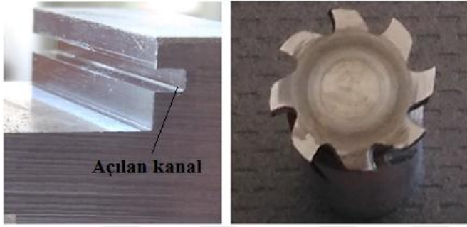
Resim 5.7. İşleme sonrası açılan kanalın ve İTEK T kanal freze çakısının resmi ( V=200 m/dak, f=0,01 mm/diş)
