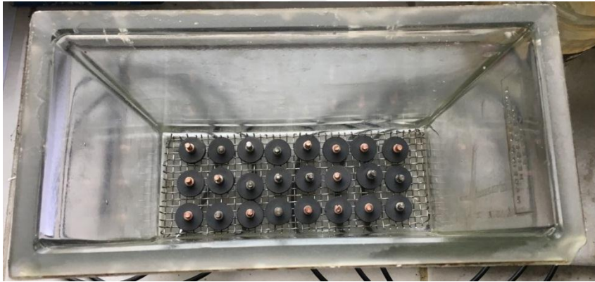
Resim 4.7. Deney numunelerinin çözücüyle bağlayıcı giderme işlemi
